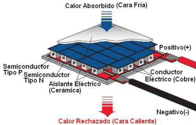
Figura 2.3: Diagrama de un módulo termoeléctrico. Tomada de [51]
