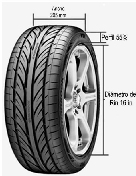
Figura 13. Medidas generales de un neumático con rin de 16 pulgadas [25].
