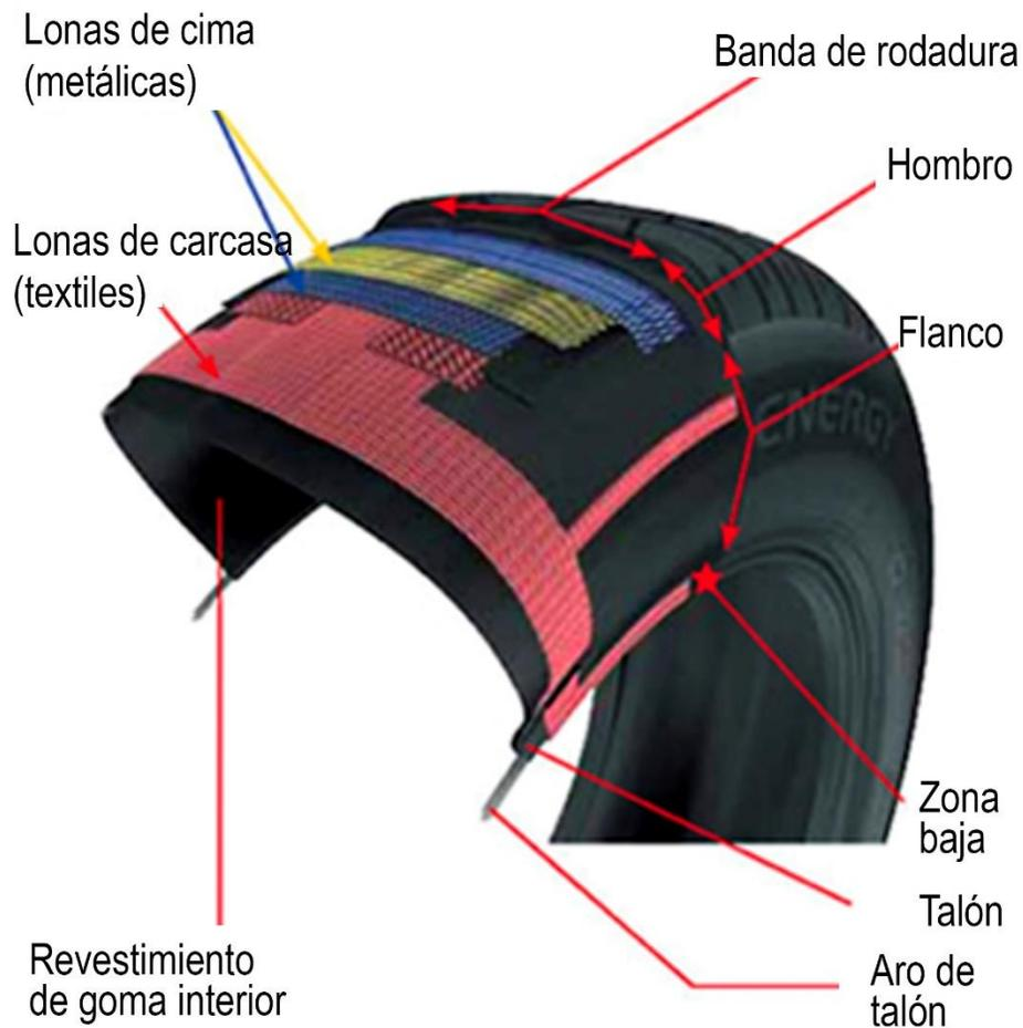
Figura 1. Partes de un neumático de automóvil [11].
