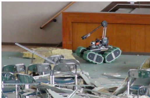
Figura 1.8: Robot Kohga 3 inspeccionando un gimnasio [8].
