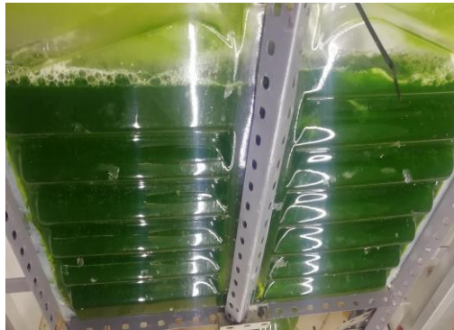
Figura 23. Estructura del fotobiorreactor.
