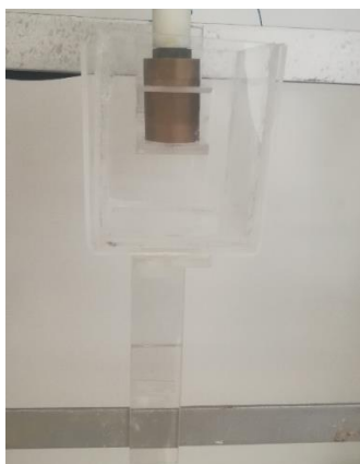
Figura 14. Celda fabricada para el estudio de PAR.
