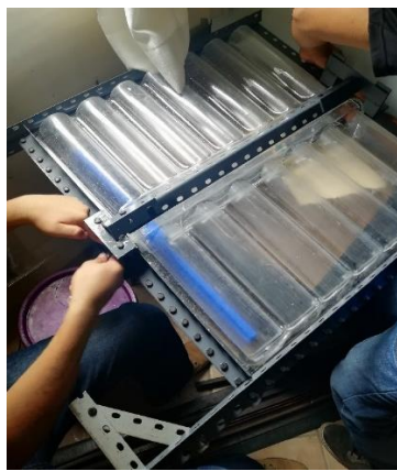
Figura 22. Atornillado de la estructura.
