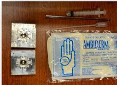
Fig. 6.19 Herramientas para la fabricación de la lente elástica.
