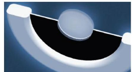
Fig. 3 Vista de sección del dispositivo que muestra una lente llena con fluido rodeada por un actuador de músculo artificial. [Imagen tomada de, (Capri, Frediani, Turco & De Rossi, 2011)]
