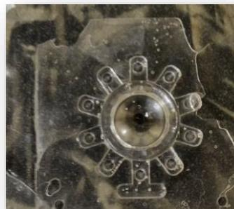
Fig. 6.22 Lente experimental de PDMS
