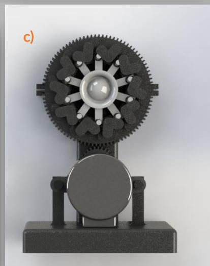
Fig. 5.16. -a) Acercamiento al sistema de sujeción de la lente TSEL, b) Vista lateral del subsistema de lente, c) Vista frontal del subsistema de lente con los actuadores.
