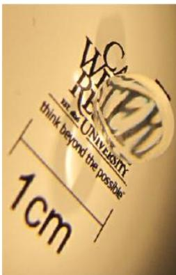
Fig. 1. Imágenes de las lentes GRIN esféricas bioinspiradas del ojo humano anterior y posterior. [Imagen tomada de, (JI, et. al., 2012)]
