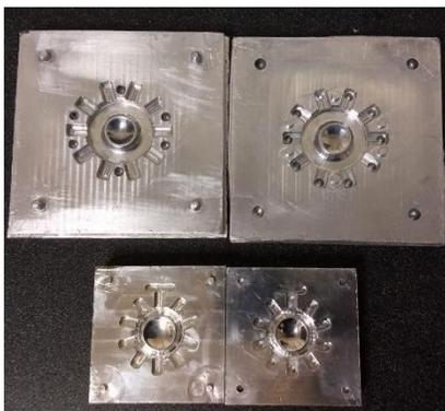
Fig. 6.17 Molde anterior (superior), molde actual (Inferior).
