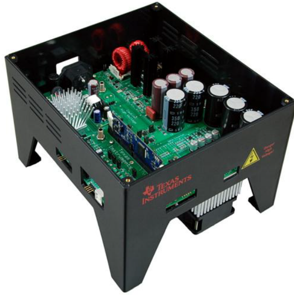
Figura 4.2: Kit de Texas Instruments para el control de motores PMSM.
