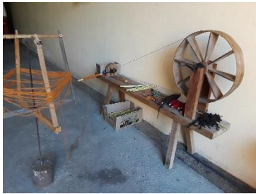
Figura 135. Elaboración de canillos en rueca
