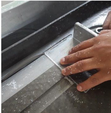
Figura 122. Escuadra y corte del material
