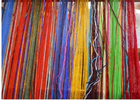
Figura 7. Irregularidad en la tensión de los hilos de la tela de urdimbre. Fuente: Propia
