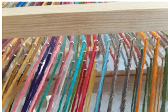
Figura 150. Hilos libres de nudos durante el proceso en urdidor
