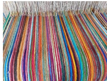
Figura 148. Tela de urdidor sobre enjullo del telar
