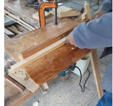
Figura 127. Canaletas rebajadas con router
