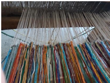
Figura 146. Amarre de la tela sobre el telar
