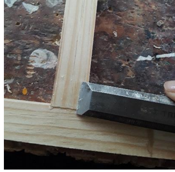
Figura 126. Excesos eliminados con formón
