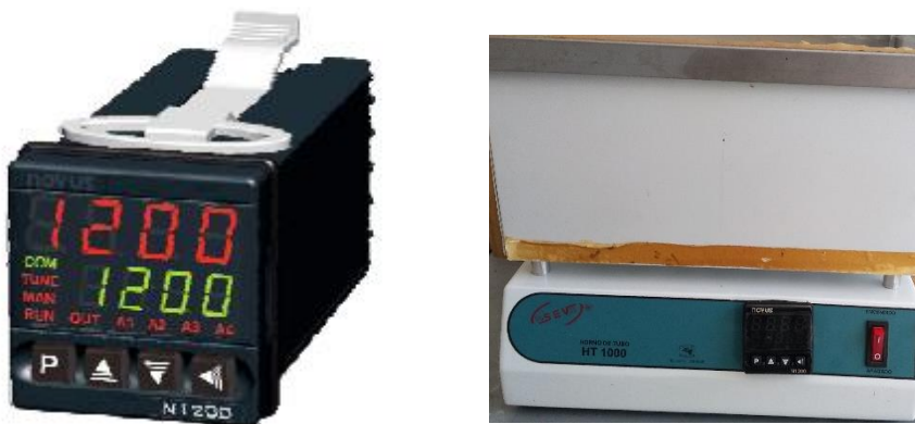
Figura 5.1 Controlador Novus N1200 acoplado a horno tubular HT100 SEV.
