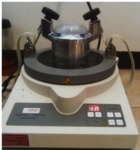
Figura 3.4 Molienda de los trozos de hueso en el molino de bolas vibratorio.
