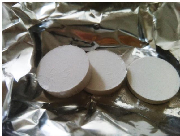
Figura 3.6 Polvos compactados en la prensa hidráulica.
