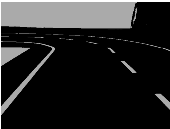
Figura 3.19: Eliminación de área visible del chasis del carro.
