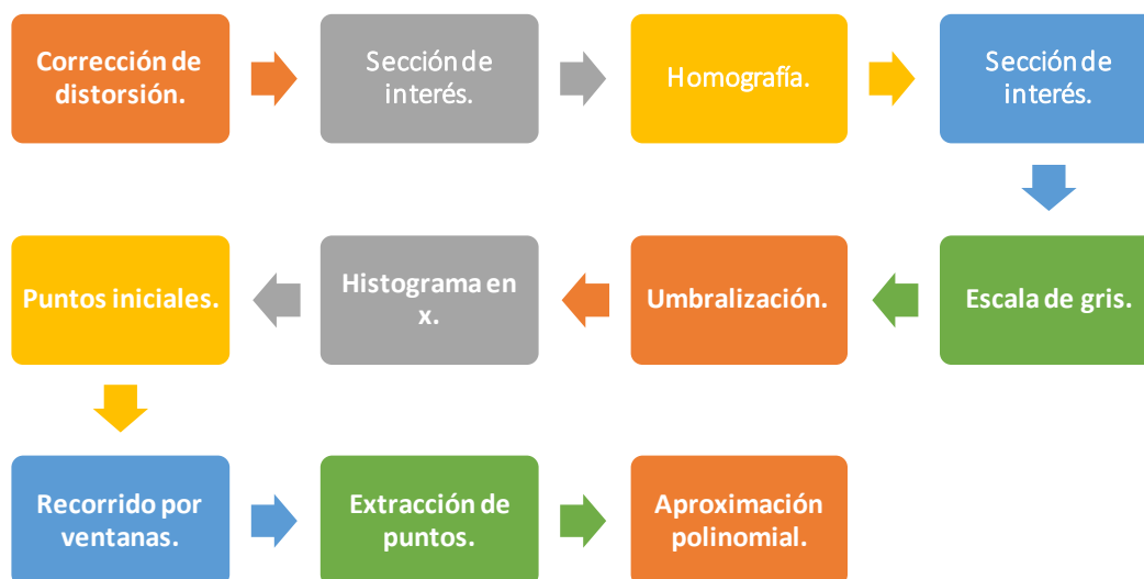
Figura 3.7: Etapas de la detección de carriles utilizando ventanas.
