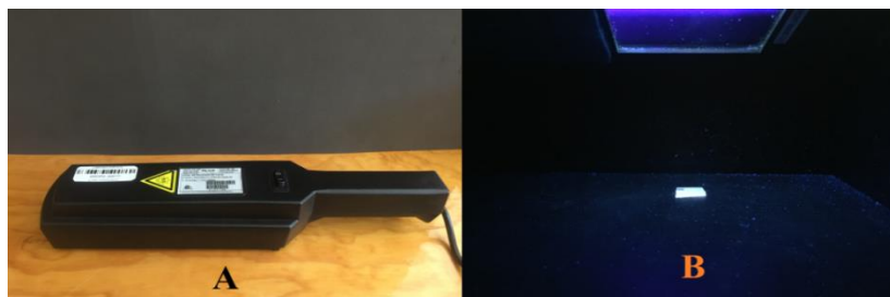
Figura 3.7. a) lámpara UV utilizada y b) inspección de la muestra.
