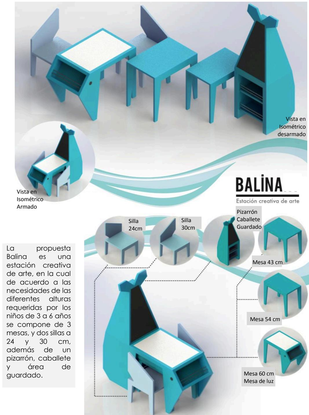
Fig 53 .Propuesta Balina, vistas isométricas del mueble en uso y armado.
