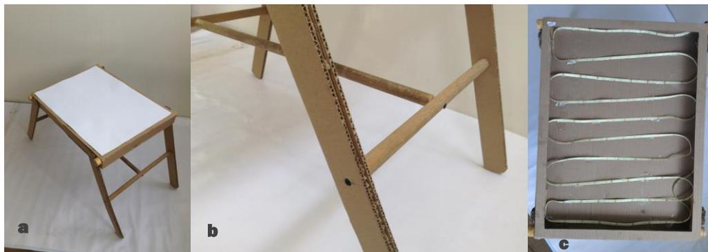
Fig 59. Modelo de cartón de la mesa de luz ajustable, a) Mesa de luz, b) Sistema tipo compás para ajustar a varias alturas, c) Luces LED al interior de la mesa.
