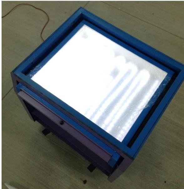
*Fig. 82 Instalación de luces LED a la mesa de luz.*
