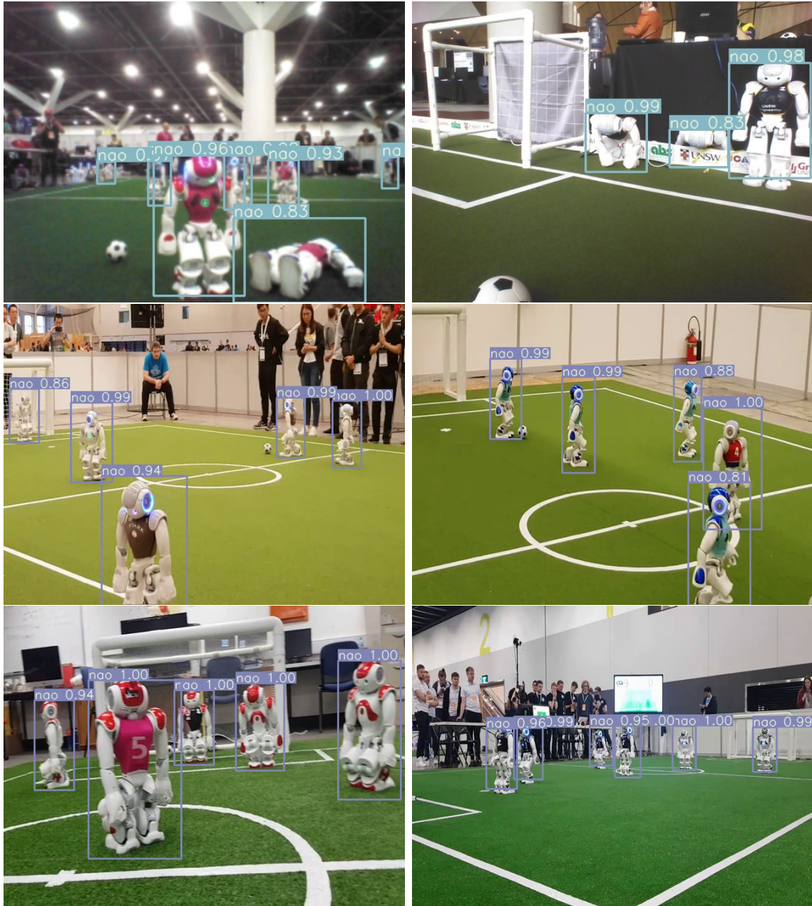
Figura 4.28: Ejemplos de detección de robot NAO con modelo TYR-NAO.
