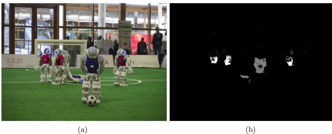
Figura 3.27: (a) Imagen original. (b) Imagen segmentada de acuerdo a los valores HSI de los colores presentes en los uniformes de los robots.
