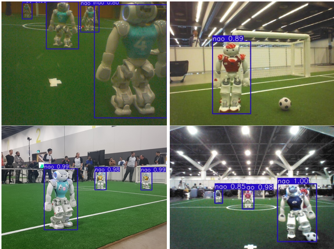
Figura 4.18: Ejemplos de detección de robot NAO con modelo tinyYOLO2-TL.
