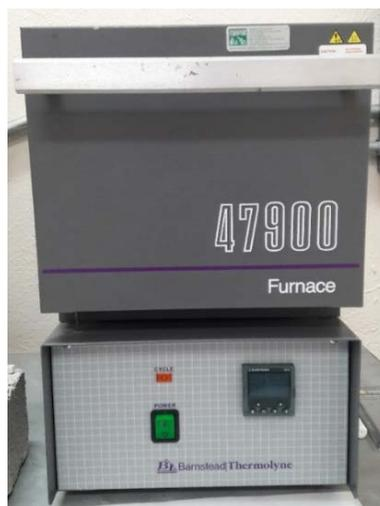
Figura 3.14 Horno Thermolyne modelo 47900.
