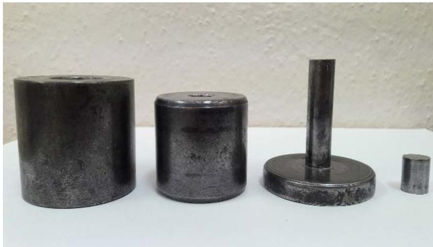
Figura 3.4 Molde metálico utilizado para el prensado.
