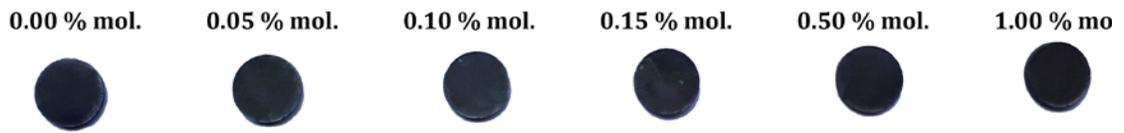
**Figura 4.8** Materiales cerámicos del sistema  $\text{SnO}_2 - \text{CoO} - \text{Nb}_2\text{O}_5 - \text{Cr}_2\text{O}_3 - \text{Bi}_2\text{O}_3$  con diferente cantidad de óxido de niobio. Los valores del  $\text{Nb}_2\text{O}_5$  están indicados cerca de cada pastilla. La sinterización de las pastillas fue realizada a  $1300\text{ }^\circ\text{C}$  (1 h).
