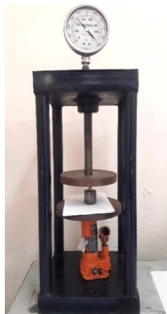
Figura 3.6 Prensa hidráulica.
