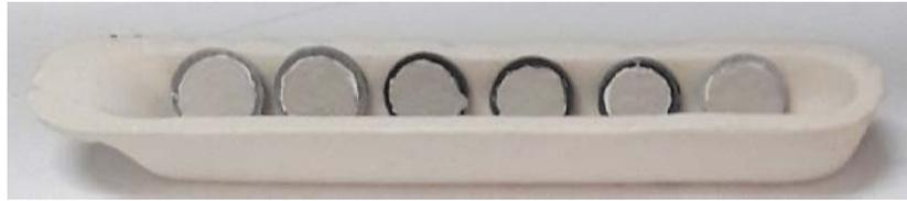
Figura 3.12 Pastillas con pintura de plata en un contenedor.
