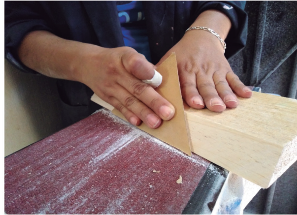
Figura 81. Lijado a 45° de los borde de las piezas de los recipientes. Fuente: Elaboración propia.
