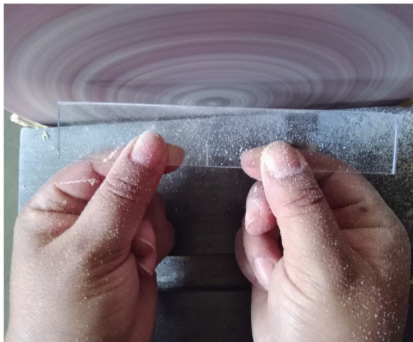
Figura 82. Lijado de las piezas para quitar imperfecciones de corte. Fuente: Elaboración propia.
