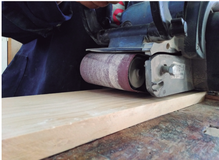
Figura 75. Lijado de piezas. Fuente: Elaboración propia.
