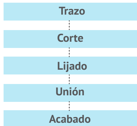
Figura 71. Proceso de fabricación de base. Fuente: Elaboración propia.
