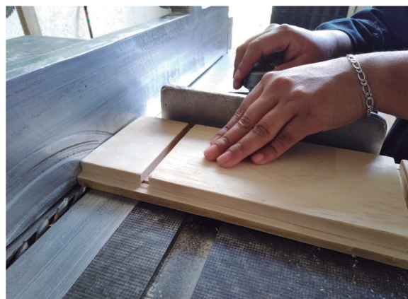
Figura 74. Corte de piezas en la sierra de banco. Fuente: Elaboración propia.
