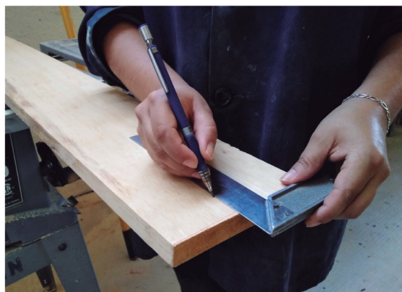
Figura 73. Trazo de las piezas de la base. Fuente: Elaboración propia.
