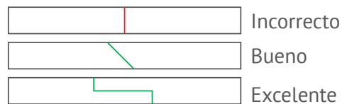
Figura 65. Tipos de uniones de láminas acrílicas. Fuente: http://cort.as/-KZg0
