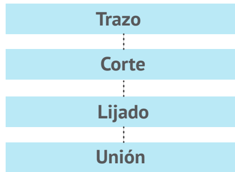
Figura 72. Proceso de fabricación de recipientes. Fuente: Elaboración propia.
