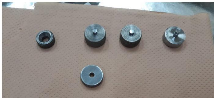
*Figura 3.10 Dados y botador para hacer pastillas de 7 mm de diámetro.*
