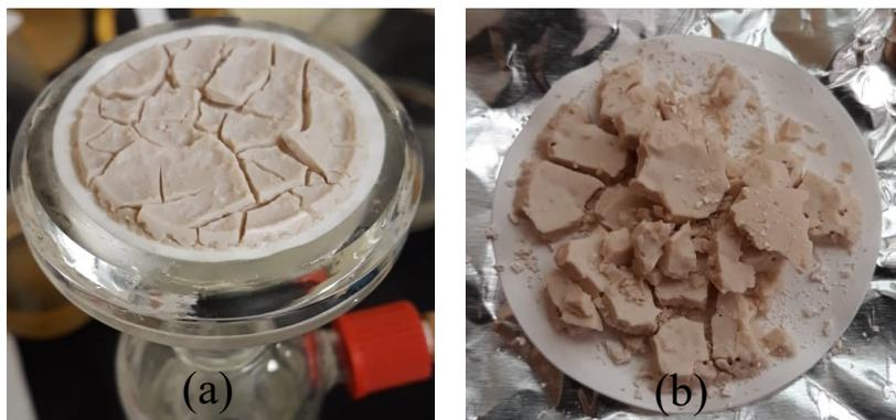
*Figura 4.4 (a) Sólidos recuperados, (b) Secado de sólidos.*
