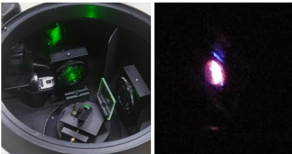
*Figura 4.14 Muestras montadas para el estudio de PL.*
