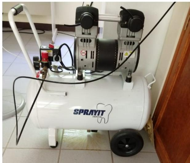
*Figura 3.7 Compresor de aire seco con diafragma.*
