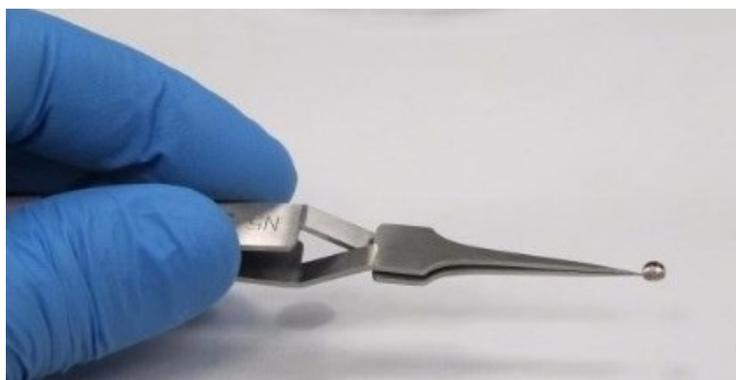
*Figura 3.9 Rejillas de cobre.*
