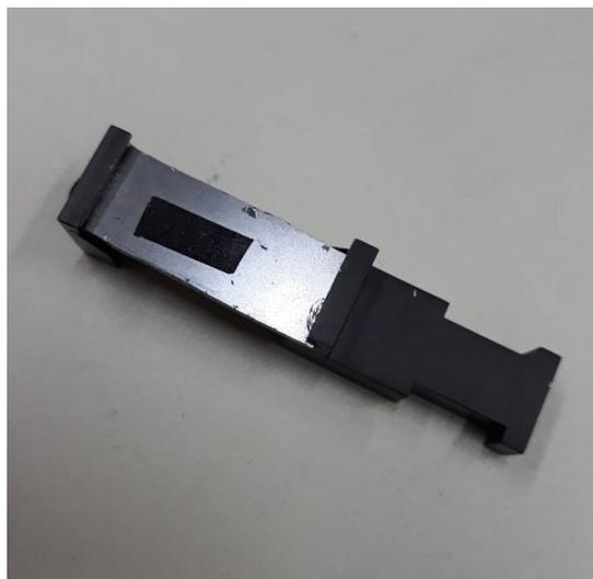
*Figura 3.12 Porta muestras para equipo de espectrofluorescencia.*
