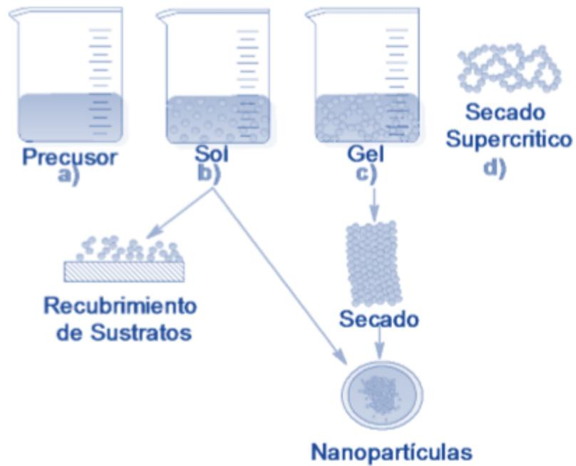
Figura 2.5 Método sol-gel a) solución del precursor, b) condensación, c) gelación, d) secado de las nanopartículas sin necesidad de aplicar temperatura.
