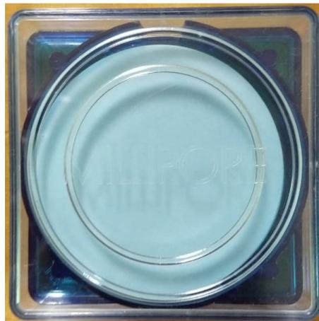
*Figura 3.4 Papel filtro MILLIPORE de 20 micrómetros.*
