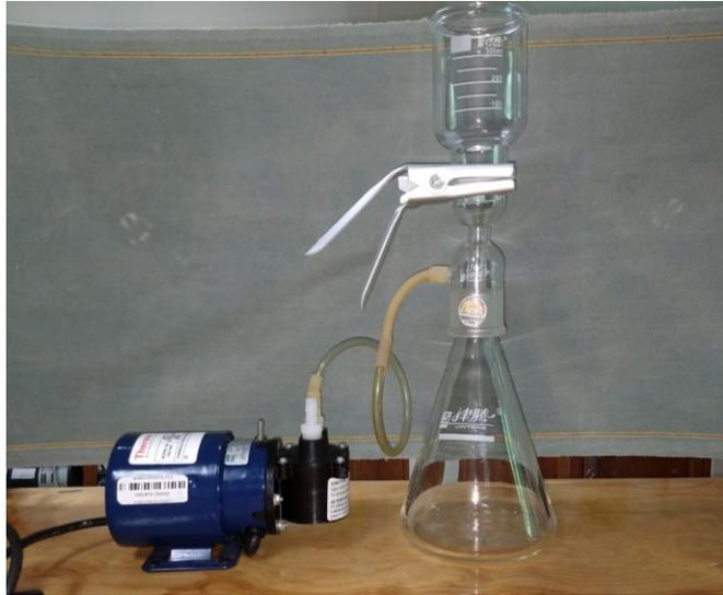
*Figura 3.3 Equipo de filtración marca JINTENG acoplado a una bomba de vacío THERMO SCIENTIFIC.*
