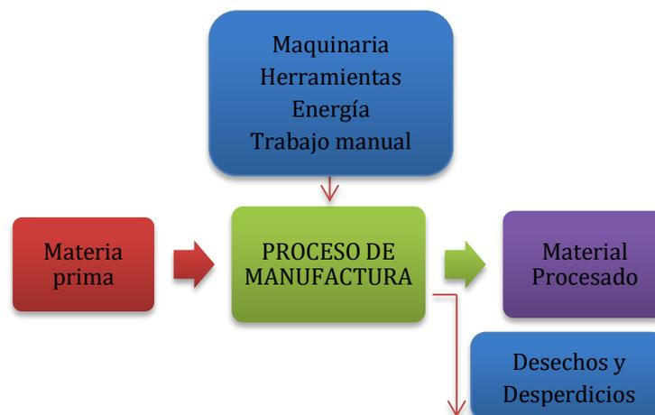
Figura 2.29 Elementos de la manufactura tradicional [45].
