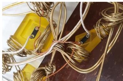
**Figura 4.5** Montaje de leds en el interior de las piezas finales de resina. Fuente propia.
