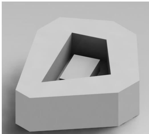
**Figura 28.** Renderización del molde de caucho de la pieza 5.
