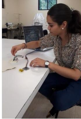
**Figura 4.3** Arduino Lilypad, cable USB y pieza de resina con led integrado. Fuente propia.
