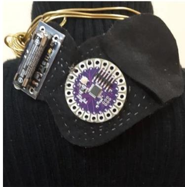
**Figura 4.8** Instalación del Arduino en la parte trasera del collar.
