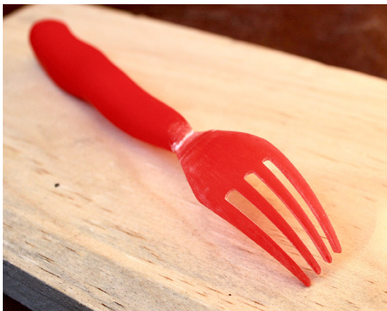
Figura 128. Acabado de las piezas después de lijar. Fuente: Elaboración propia
