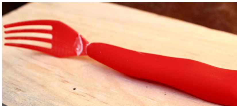
Figura 132. Prototipo de tenedor lijado Fuente: Elaboración propia
