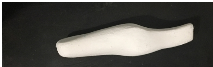
Figura 107. Modelo del mango del cuchillo para escanear. Fuente: Elaboración propia
