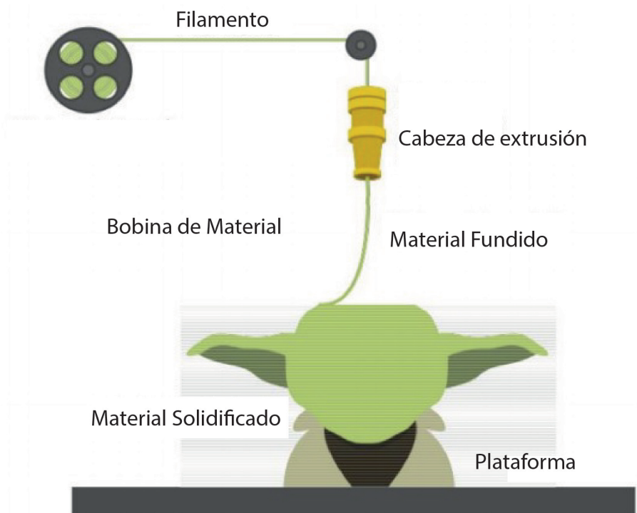
Figura 33. Modelación por Deposición Fundida. Fuente: 3D Printing Industry
