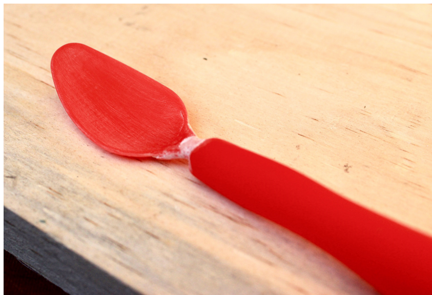
Figura 131. Prototipo de cuchara lijado Fuente: Elaboración propia
