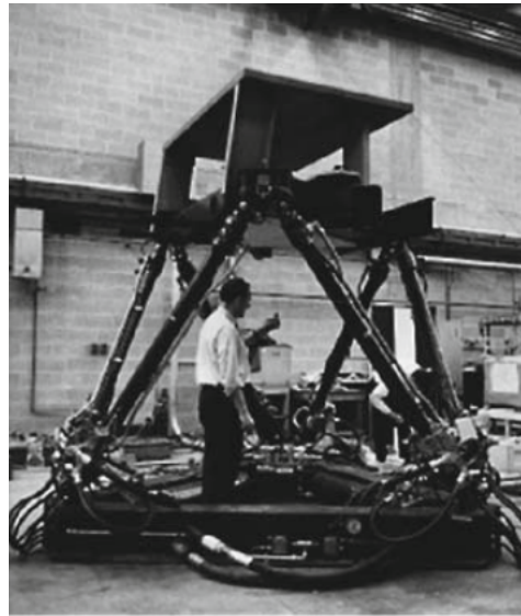
Figura 1.3: Simulador de vuelo de Helicóptero diseñado por Cappel en 1962 [1].
