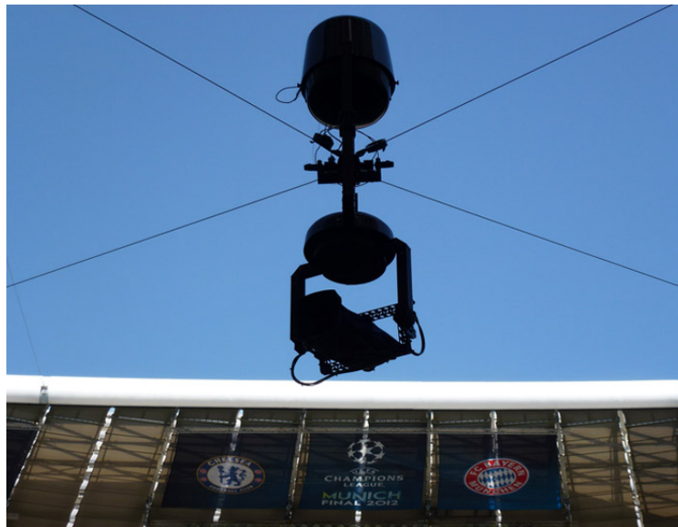
Figura 1.5: Ejemplo de robot paralelo accionado por cables (SPIDERCAM). [6]
