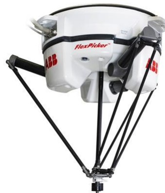
Figura 1.4: Robot DELTA Flexpicker de ABB [5].
