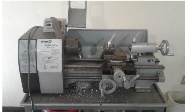
Figura 3.24: Mini torno utilizado para la manufactura de los pasadores.
