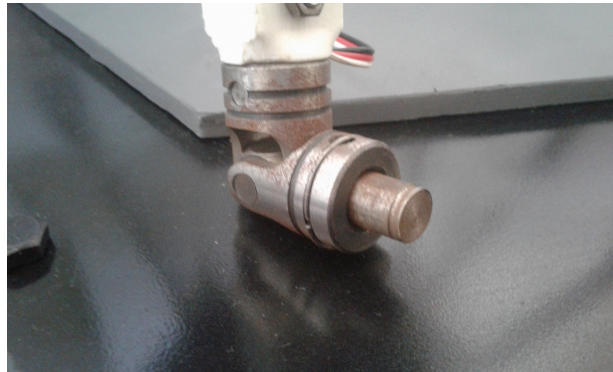
Figura 3.26: Pasador terminado y colocado en la junta universal.
