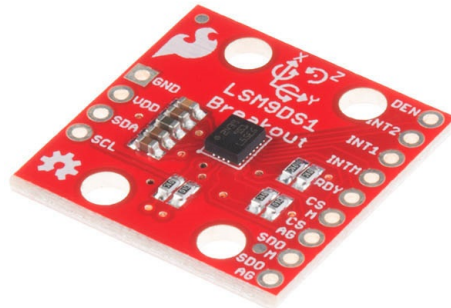
Figura 5.8: Unidad de medición inercial LSM9DS1.
