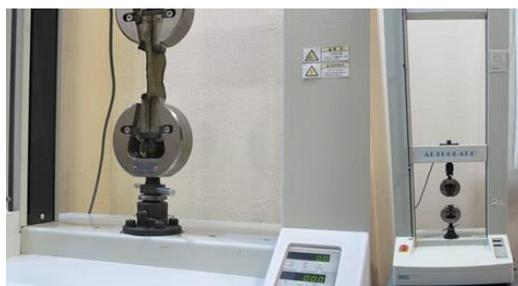
**Fig. 3.3 a)** Ensayo a la tracción de la muestra de la tela shantung sin hilo (derecha), **b)** Máquina universal Shimadzu AG – IS (Izquierda).
