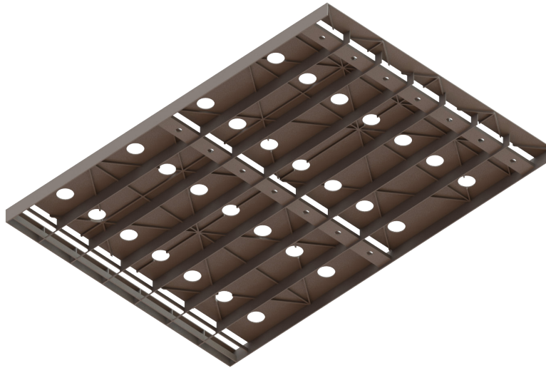
Figura 62. Retícula en la tapa del contenedor Fuente: Elaboración propia, 2018.
