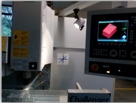
Figura 44. Maquinado empleando el ciclo de taladrado (Fuente: Propia).
