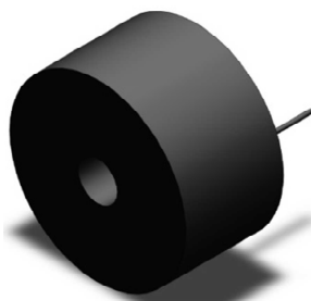
Figura 49. Buzzer (Fuente: Propia).
