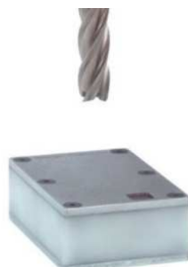
Figura 10. Localizador electrónico de eje "Z" (Traverstool, 2017).
