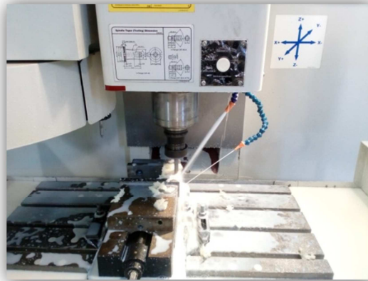
Figura 42. Maquinado de la carcasa en el CMV (Fuente: Propia).
