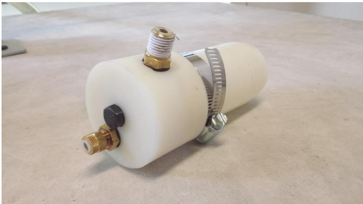
Figura 4-8 Reservorio para los precursores en forma de aerosol.
