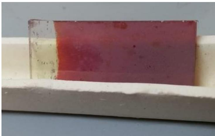
Figura 4-22 Película de hematita obtenida después del tratamiento térmico a  $550^\circ\text{C}$ .
