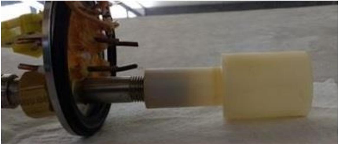
Figura 4-3 Tapa de brida terminada con conexiones y soporte de Nylamid.
