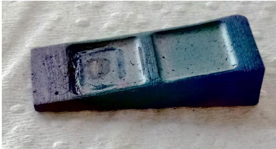
Figura 4-6 Susceptor en forma de cuña terminado.
