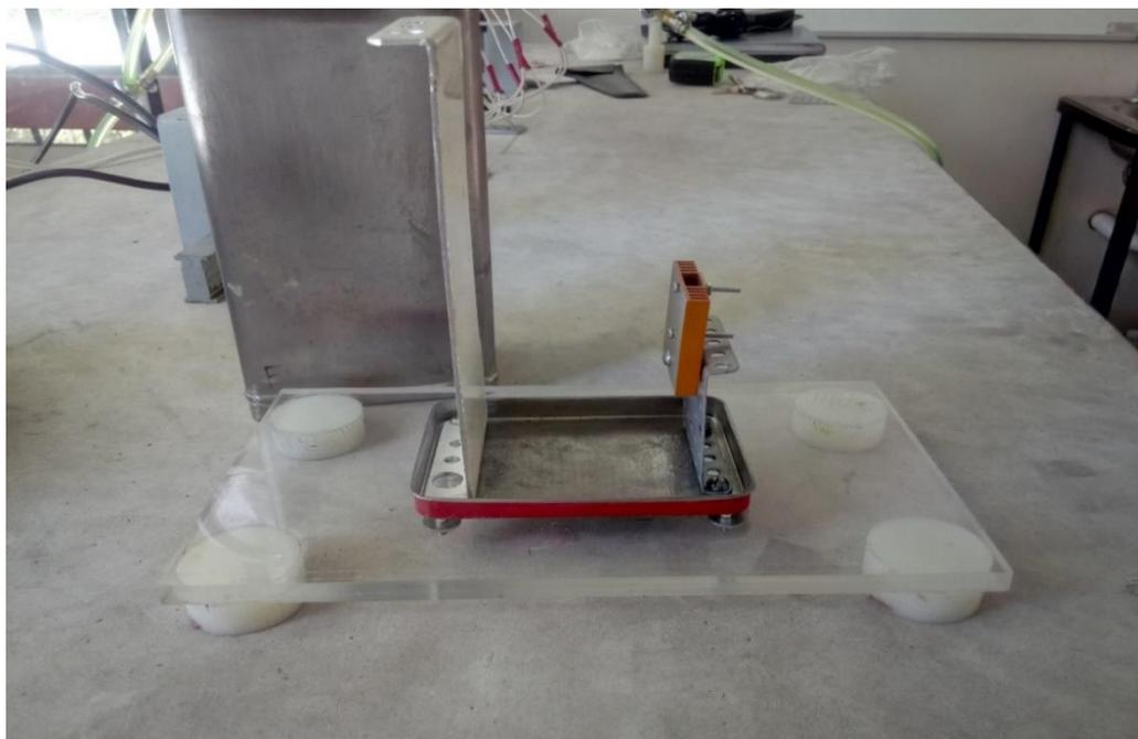
Figura 4-21 Contenedor blindado para caracterización por voltamperometría cíclica.
