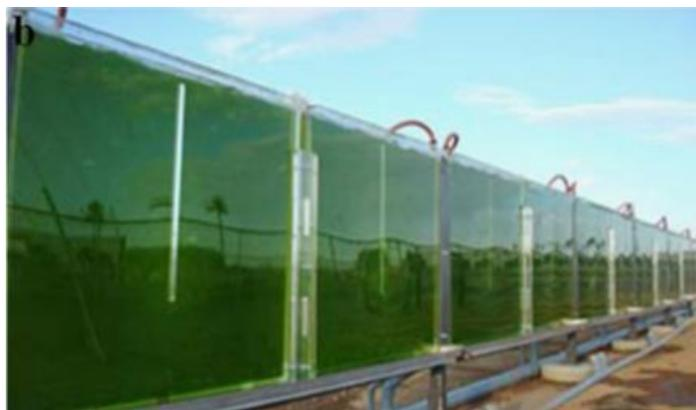
Figura 5.3 Fotografía de un fotobiorreactor de placas planas. Se muestra un arreglo en serie de varios fotobiorreactores (Bitog J.P. et al. 2011)
