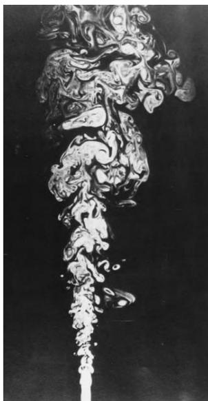
Figura 9.3 Visualización de un chorro de flujo donde se aprecia lo caótico que puede ser un fluido debido a la turbulencia (Versteeg H. et al. 2007)
