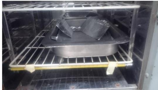
*Figura b2. a) Matraz kitasato conectado a bomba de vacío, b) Biomasa recién extraída con el filtro, c) Filtro dentro del horno para extraer humedad*
