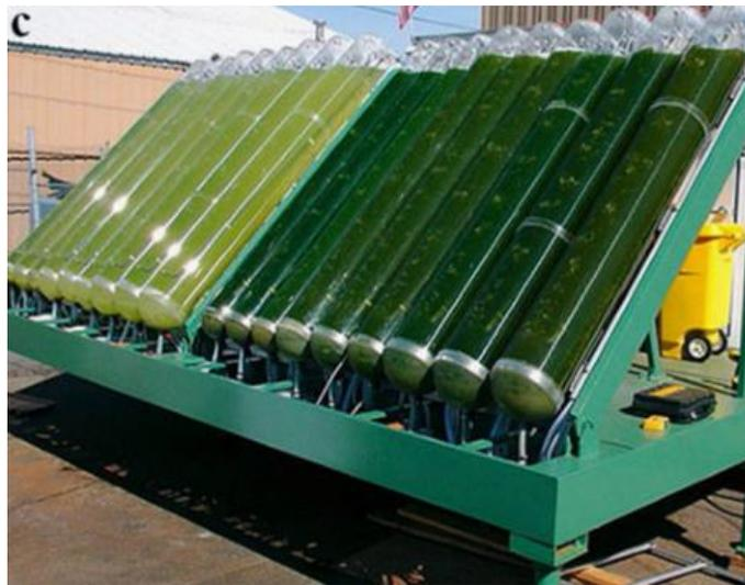
*Figura 5.2 Fotografía de un fotobiorreactor columna de burbujeo (Bitog J.P. et al. 2011)*
