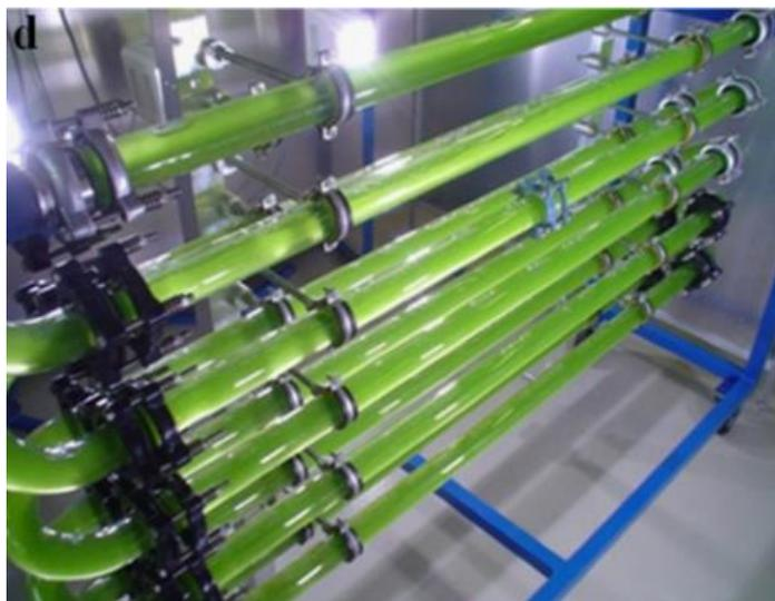
Figura 5.4 Fotografía de un fotobiorreactor tubular (Bitog J.P. et al. 2011)
