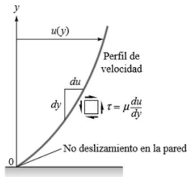
Figura 6.3. Deformación de un fluido al aplicar esfuerzo cortante (White F. 2003)
