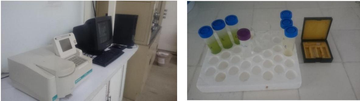
Figura 10.5. a) Sistema de captura de espectro electromagnético computadora y espectrómetro BECKMAN modelo DU530 (Izquierda), b) Muestras de cultivo y celdilla para espectrómetro (Derecha)
