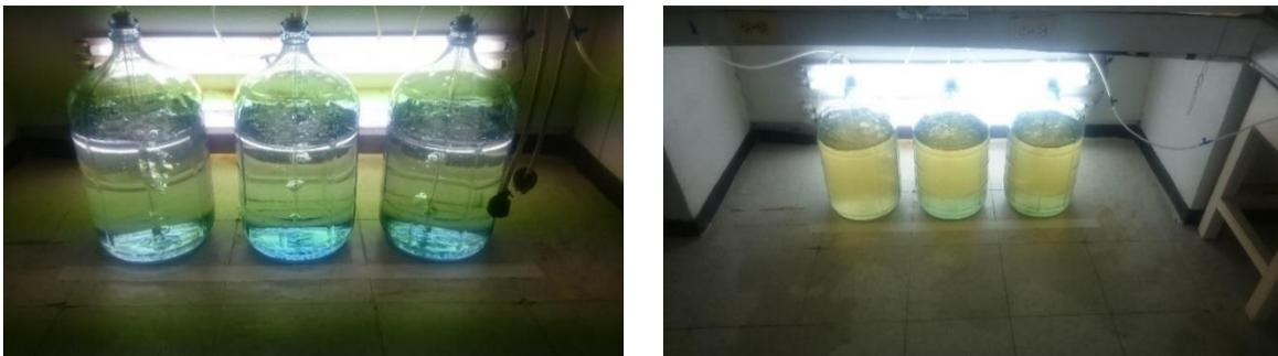
Figura 10.2. a) Fotobiorreactor con medio de crecimiento (izquierda), b) Fotobiorreactor después de inocular (Derecha)
