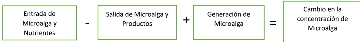
Figura 5.8. Balance de masa en un fotobiorreactor en modo continuo
