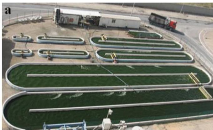
Figura 5.1 Fotografía de un fotobiorreactor de pista abierta, se aprecian sus distintos tamaños (Bitog J.P. et al. 2011)
