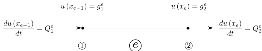
(b) Un elemento típico, con la definición de las variables primarias ( u ) y secundarias ( Q ) en los elementos nodales.
