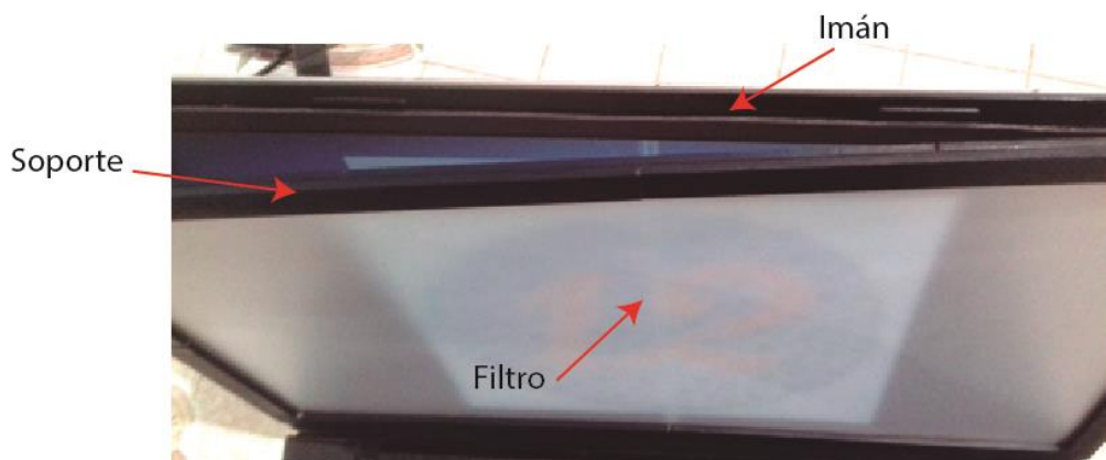
Figura 3.90 Imagen de los imanes en laptop y el filtro dentro del marco. Fuente: Elaboración propia.
