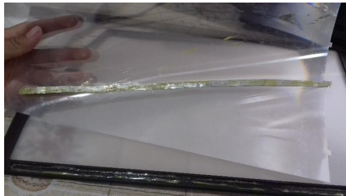
Figura 3.87 Recubrimiento del pegamento en las superficies de contacto. Fuente: Elaboración propia.
