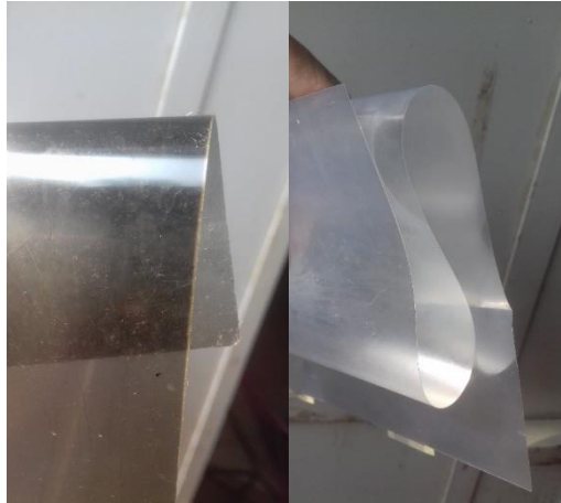
Figura 3.2 Deformaciones en el filtro que ocasionan distorsiones ópticas y dañan el material. Fuente: Elaboración propia.
