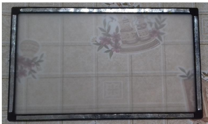
Figura 3.89 Imagen del soporte con el recubrimiento de metal en las áreas designadas. Fuente: Elaboración propia.
