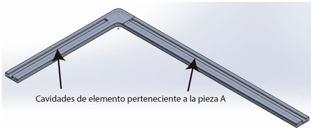
Figura 3.57 Modelo cinco. Cavidad de elementos de la pieza A. Fuente: Elaboración propia.
