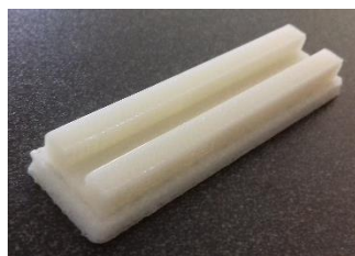
Figura 3.66 Imagen de la muestra impresa en ABS, la cual representa al elemento A del modelo 5. Fuente: Elaboración propia.
