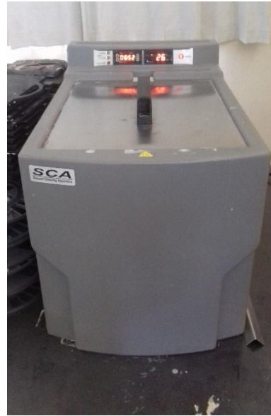
Figura 3.77 Baño caliente de sosa. Fuente: Elaboración propia.
