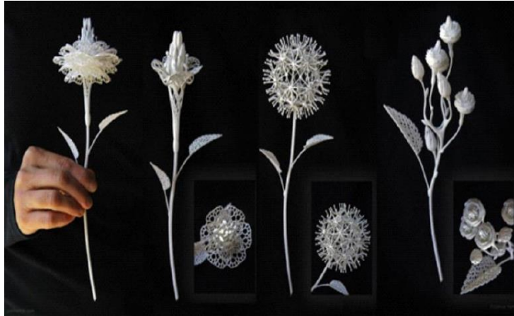
Figura 2.17 Ejemplo de piezas impresas por impresión fusión de lechos de polvo. Fuente: Make Magazine, 2012.
