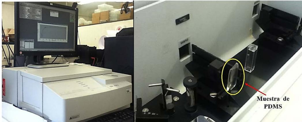
**Figura 4.12.** Espectrómetro UV-Visible Unicam UV300 (laboratorio de películas delgadas de la BUAP).
