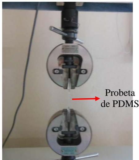
**Figura 4.4.** Ensayo a la tracción de una probeta de PDMS.
