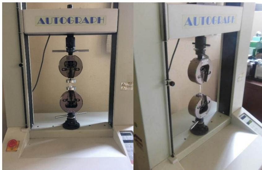
**Figura 4.1.** Máquina universal para ensayos mecánicos Shimadzu Modelo Autograph AG-IS.
