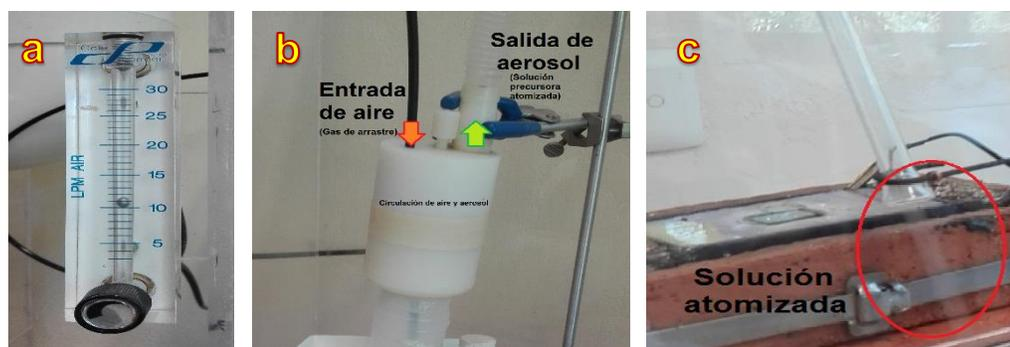
Figura 3.8 a) Regulador de gas de arrastre (Flujómetro). b) Proceso de circulación de solución atomizada. c) Salida de aerosol por boquilla de vidrio.
