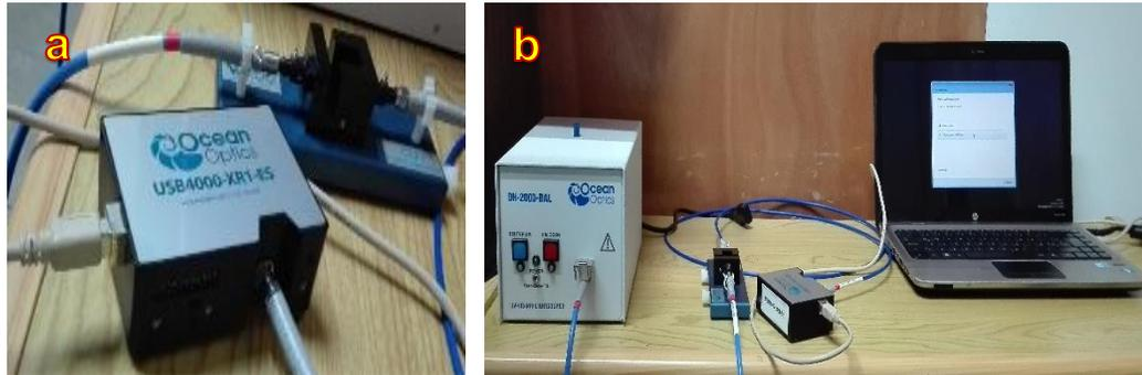
Figura 3.23 a) Espectrómetro Oceanoptics modular USB4000-XR1-ES. b) Espectrómetro, portamuestras (soporte CUV-UV), fuente de luz de deuterio y tungsteno halógeno (DH-200BAL).
