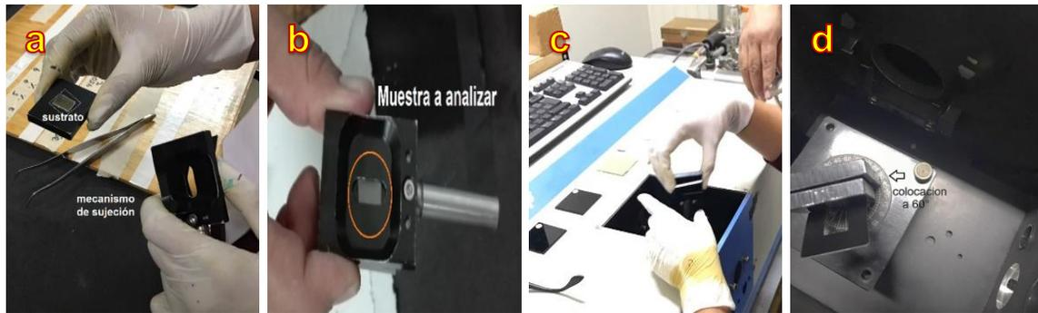
Figura 3.17 a) Colocación de sustrato en portamuestra. b) Montaje de muestra en mecanismo de sujeción. c) Inserción de mecanismo de sujeción en compartimiento del equipo. d) Posicionamiento de mecanismo de sujeción a  $60^\circ$  del haz de luz para su análisis.
