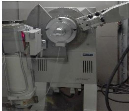
Figura 3.18 Difractómetro de haz rasante, Rigaku Dmax2100.
