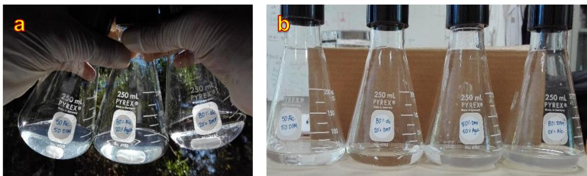
Figura 3.12 Relación de solventes en la disolución de  $Zr(C_5H_7O_2)_4$  a) 50:50 Metanol-DMF, 80:20 Metanol-agua, y 80:20 Metanol-DMF. b) 50:50 Metanol-DMF, 80:20 Metanol-DMF, 50:50 DMF-agua y 80:20 DMF-Metanol.
