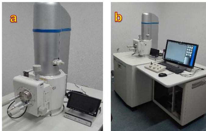
Figura 3.20 Microscopio electrónico de Barrido equipado con EDS (Energy Dispersive System), JEOL JSM-6010PLUS/LA, a) vista lateral y b) vista completa del equipo.
