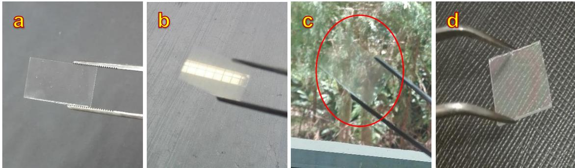
Figura 4.1 Inspección visual de película: a) De  $ZrO_2$ , b) Con luz artificial del depósito (homogéneo y semitransparente), c) Comprobando transparencia del recubrimiento  $ZrO_2$ , d) Transparencia de  $ZrO_2:Tb^{3+}$ .
