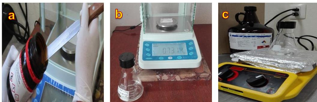
Figura 3.3 a) Pesaje de reactivos. b) Cuantificación de reactivos de acuerdo a molaridad y volumen de solventes. c) Agitación de disolución.
