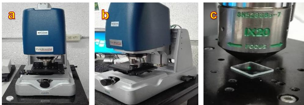
Figura 3.22 Perfilómetro óptico de mesa Bruker Contour GT, a) Vista frontal y b) Vista lateral. c) Colocación y análisis de muestra a 20X con un haz de luz verde.
