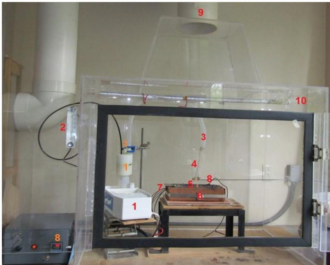
Figura 3.6 Sistema experimental RPU y componentes: 1- Nebulizador ultrasónico/ solución precursora. 2- Flujómetro. 3- Manguera corrugada /Gas de arrastre. 4- Aerosol/ boquilla. 5- Porta sustrato/ cama de estaño. 6- Sistema calefactor. 7- Resistencias. 8- Termopar/ controlador de temperatura. 9- Sistema de extracción de gases. 10- Cámara de acrílico.
