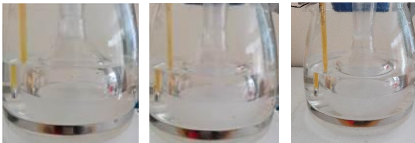
Figura 4.25 Etapa I del proceso de síntesis de ZrO_2 prueba 8 con 0.2 ml de agua desionizada
