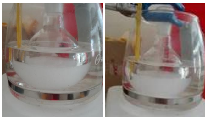
Figura 4.16 Etapa I del proceso de síntesis de ZrO_2 , prueba 5.
