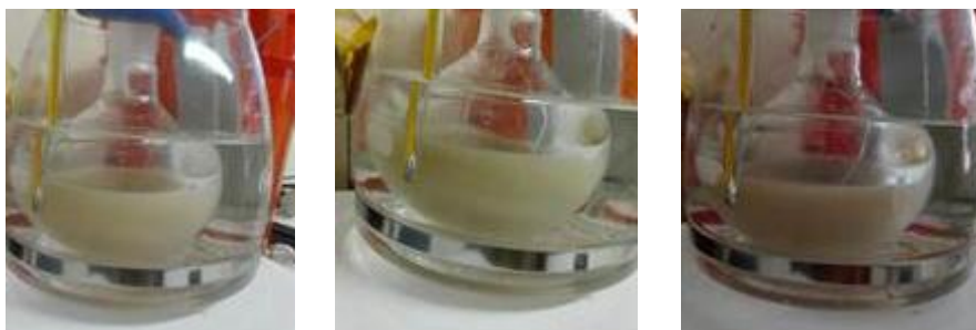
Figura 4.19 Etapa IV cambios de coloración por fases durante la síntesis de ZrO_2 , en la prueba 5
