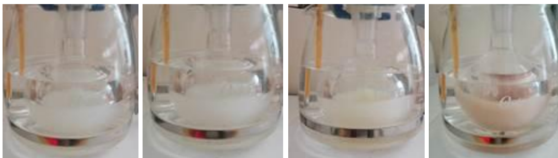
Figura 4.27 Etapa III del proceso de síntesis de ZrO_2 prueba 8 con 0.2 ml de agua desionizada
