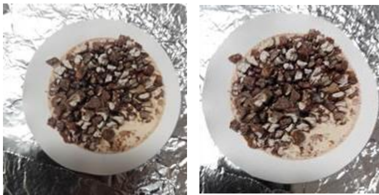
Figura 4.29 Precipitado obtenido por la técnica de Poliol con 0.2 ml de agua desionizada (muestra Z2)
