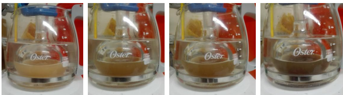
Figura 4.14 Cambios de coloración durante la etapa IV de síntesis de ZrO_2 , prueba 4
