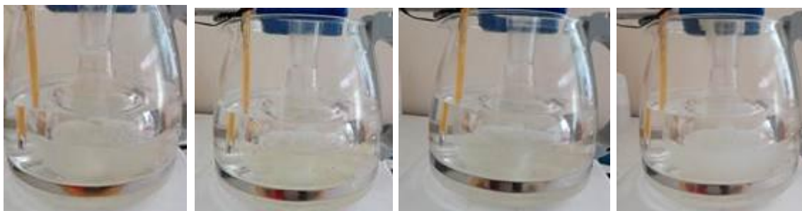
Figura 4.26 Etapa II del proceso de síntesis de ZrO_2 prueba 8 con 0.2 ml de agua desionizada
