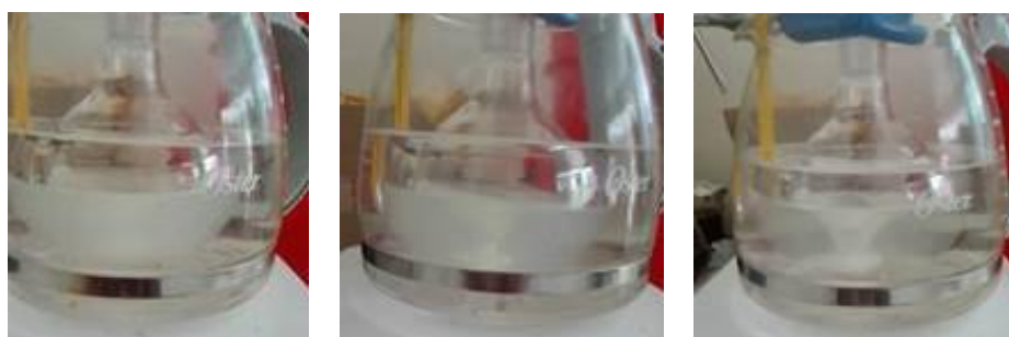
Figura 4.17 Etapa II del proceso de síntesis de ZrO_2 , prueba 5
