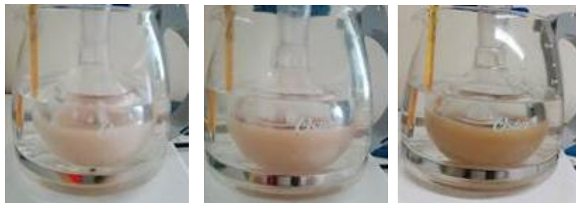
Figura 4.28 Etapa IV de la síntesis de ZrO_2 prueba 8 con 0.2 ml de agua desionizada
