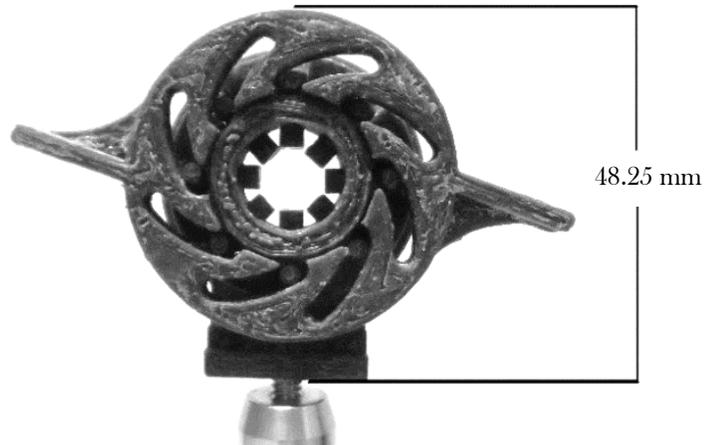
Figura 3.8.- Sistema manufacturado utilizando una impresora 3D.
