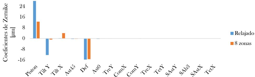
Figura 4.53.- Coeficientes de Zernike de la lente bicónica con índice de refracción homogéneo en condición de relajación y presionado en ocho zonas.
