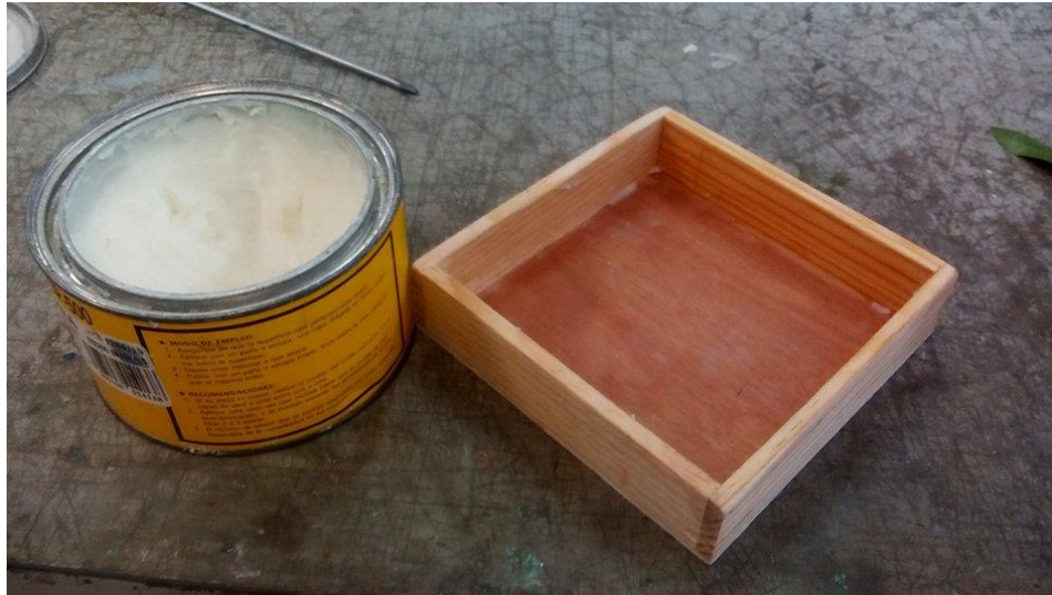
Figura 53. Molde con cera desmoldante Fuente: Elaboración propia
