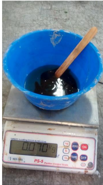
Figura 55. Preparación y control componentes líquidos Fuente: Elaboración propia
