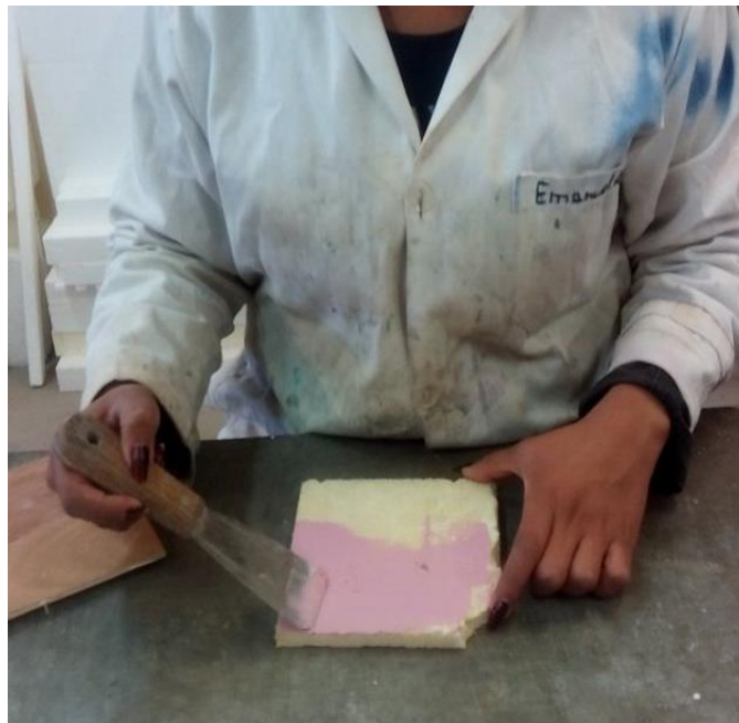
Figura 63. Recubrimiento uniforme de las piezas uniformemente Fuente: Elaboración propia
