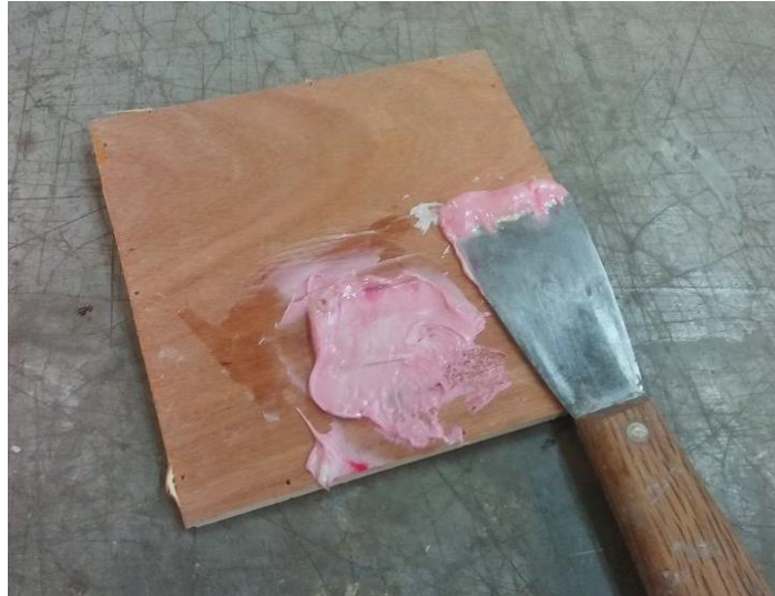
Figura 62. Pasta mezclada con catalizador Fuente: Elaboración propia
