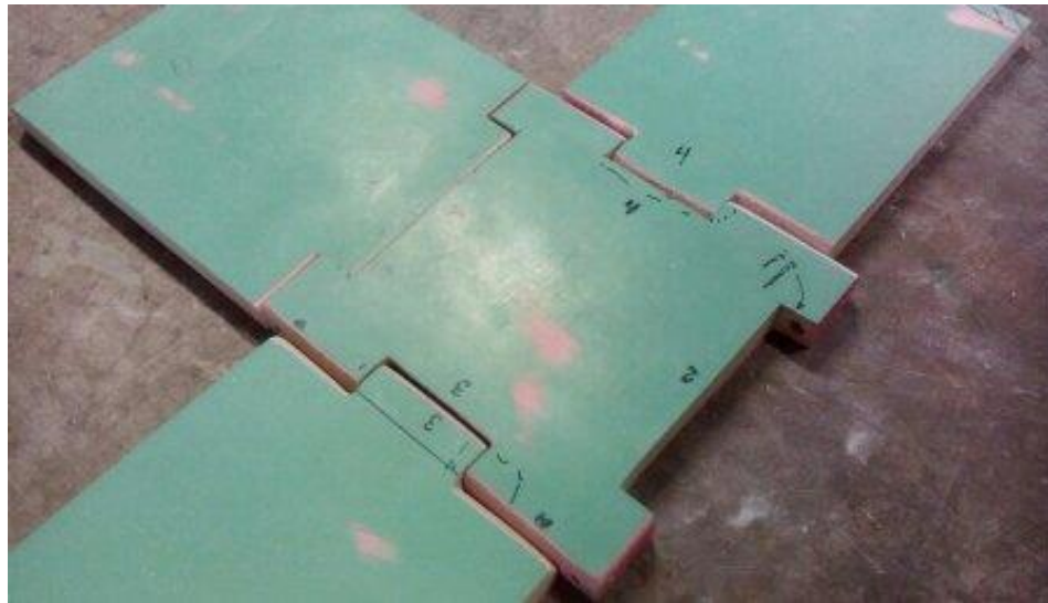
Figura 65. Ensamble de cola de milano Fuente: elaboración propia
