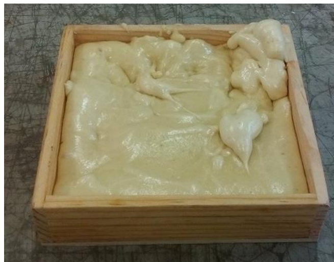
Figura 58. Mezcla catalizada Fuente: Elaboración propia
