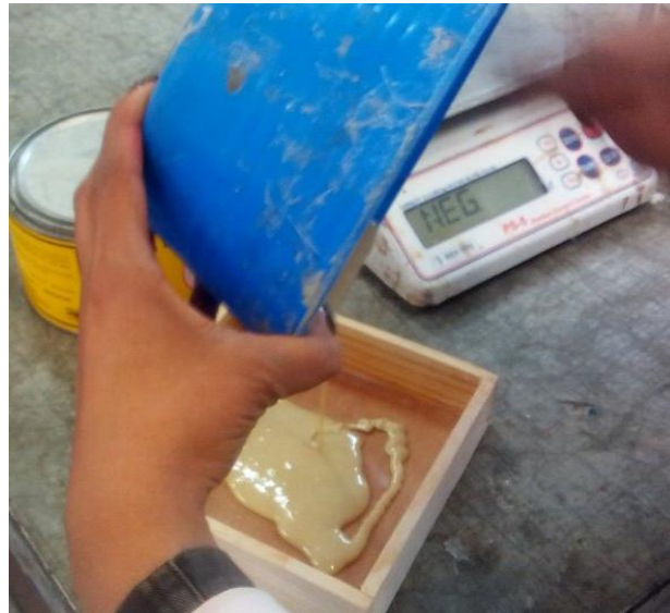
Figura 57. Distribución de la mezcla dentro del molde Fuente: Elaboración propia
