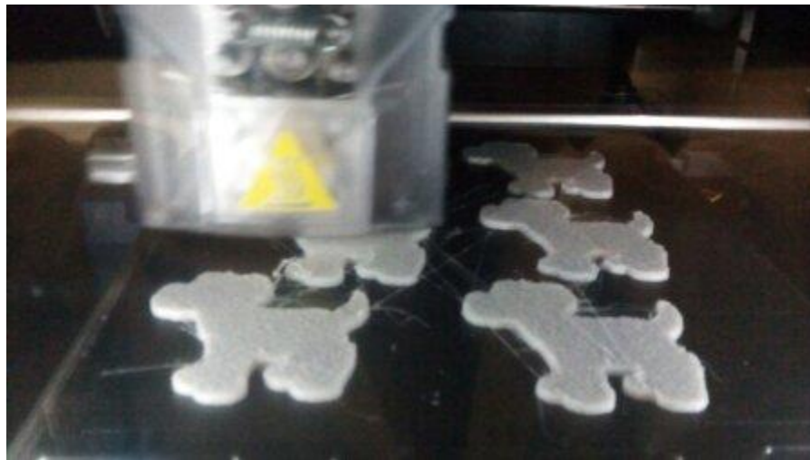
Figura 69. Piezas antes de retirarse de la Impresora 3D Fuente: Elaboración propia
