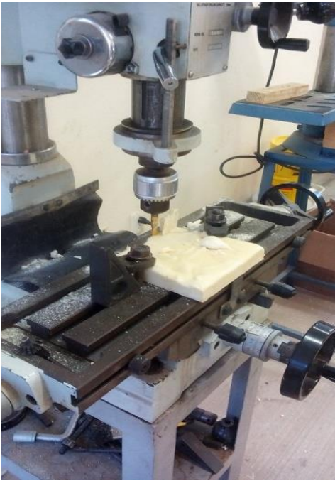
Figura 60. Pieza montada en el taladro fresador Fuente: Elaboración propia
