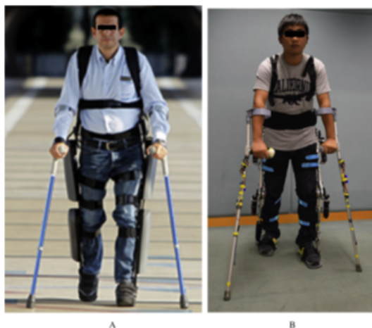
Figura 1.4: A) El sistema ReWalk Wearable. B) El exoesqueleto de la extremidad inferior desarrollado en la Universidad China de Hong Kong [17].
