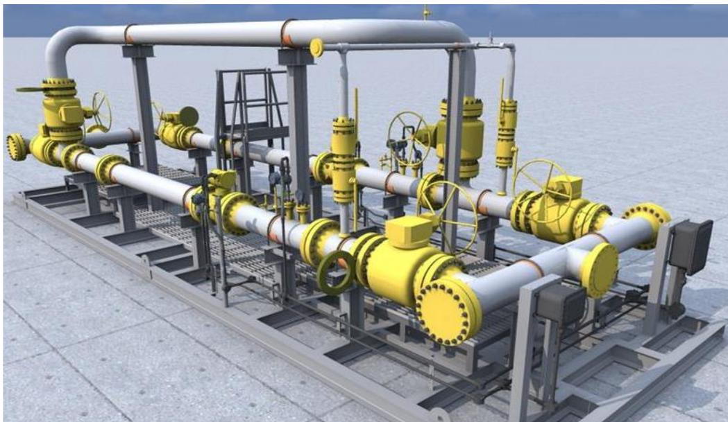
Figura 1-5 Sistema de medición con medidores ultrasónicos
