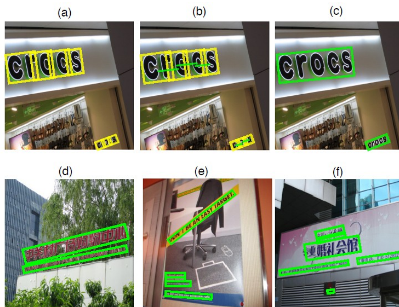
Figura 2.8: Descripción general de SegLink. a) Se detectan segmentos (cuadros amarillos) en la imagen. b) Los enlaces (líneas verdes) se detectan entre pares de segmentos adyacentes. c) Los segmentos conectados por enlaces se combinan en palabras completas. (d-f) Seglink puede detectar largas líneas de texto y además texto de idiomas diversos, como el chino (Shi et al., 2017).
