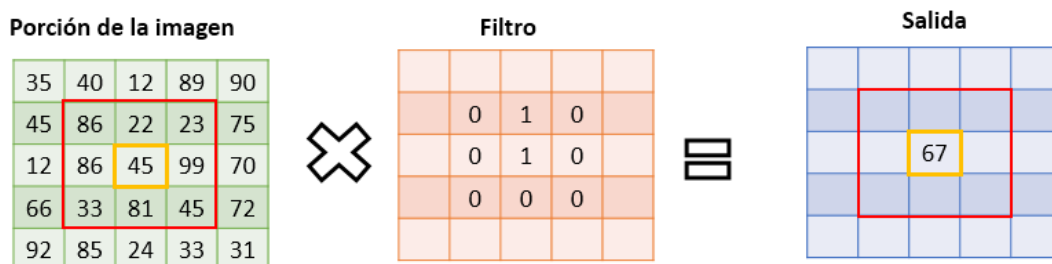
Figura 2.2: Cálculo de la convolución sobre una imagen de un solo canal y tamaño 5 \times 5 y un filtro de tamaño 3 \times 3 (Chuliá, 2016).
