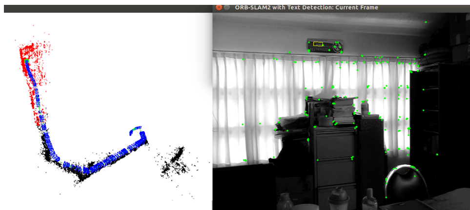
Figura 4.23: Ejemplo del funcionamiento de ORB-SLAM en la construcción de un escenario interior. En la imagen de la izquierda se presentan en verde los puntos claves de una imagen del escenario. En la imagen de la derecha se presenta la reconstrucción del mapa 3D en donde se observa: en rojo los últimos puntos claves generados que pueden utilizarse en la relocalización, en verde el recorrido de la cámara en el escenario, y en cuadros azules las posiciones de la cámara.
