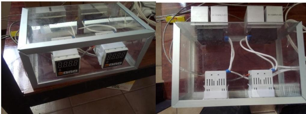
Figura 4.2. Sistema de Calefacción para los precursores.
