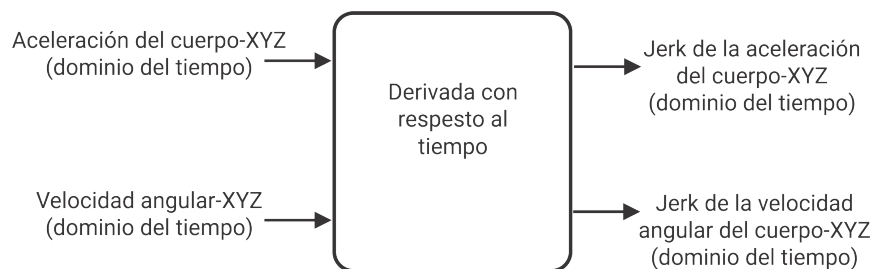
Figura 3.5: Diagrama del proceso para la obtención de las señales en el dominio del tiempo derivadas a partir de las básicas.
