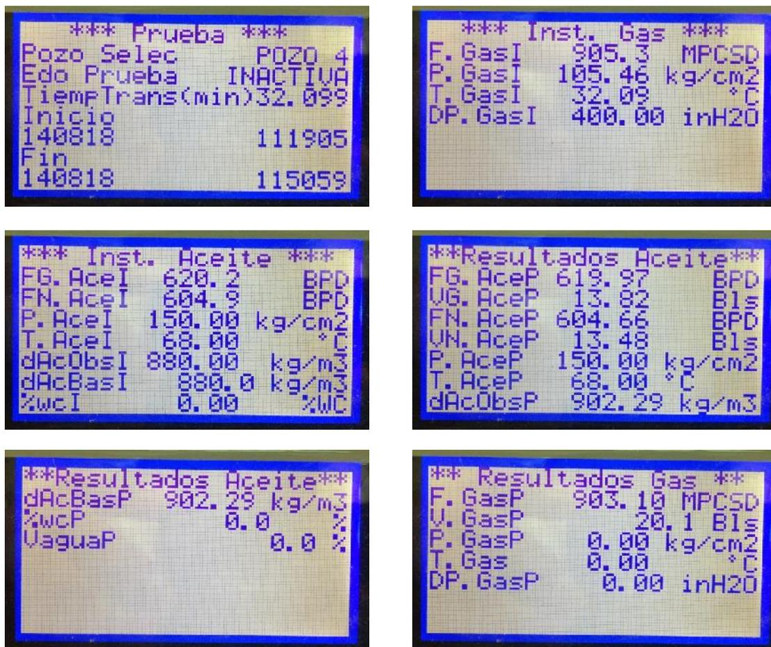
Figura A.21 Pantallas del estado de la prueba, valores instantáneos y resultados de la prueba
