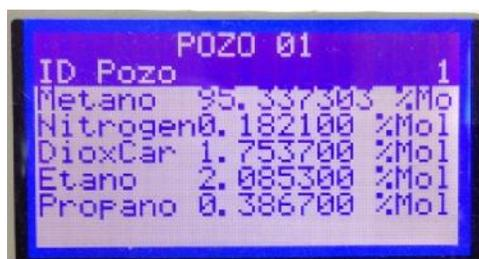
Figura A.24 Datos Cromatográficos y densidades del Pozo
