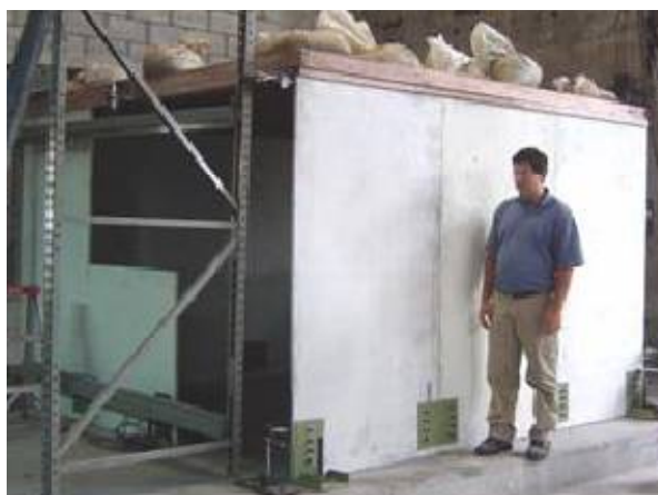
Figura 1. Modelo de vivienda de ferrocemento sometida a vibración (Bedoya, 2005).
