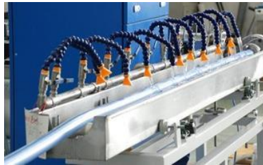
Figura 3.23. Tanques de enfriamiento por esparado. Fuente: (Industrial Ambar, 2017).
