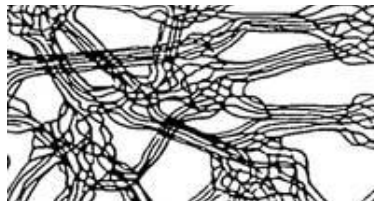
Figura 2.8. Estructura molecular de un termoplástico amorfo. Fuente: (Ensinger, 2016a).
