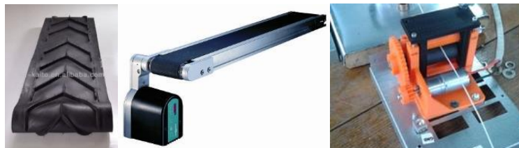
Figura 3.26. Unidad de tiro por: (De izq. a der.) Oruga, banda, rodillos. Fuente: Google Imágenes.
