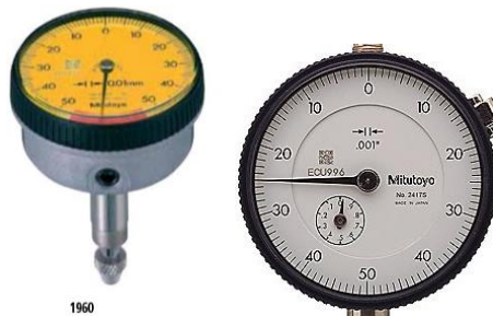
Figura 4.40. Indicador de carátula tipo vástago posterior (Imagen izquierda) y Carátula 50-0-50 (Imagen derecha).
