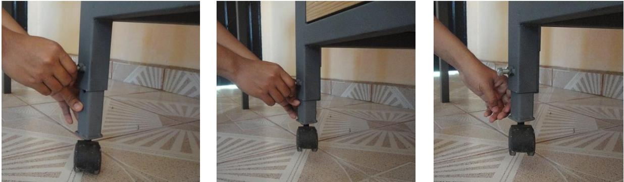
Figura 83. Adaptación de altura. Fuente: Elaboración propia
