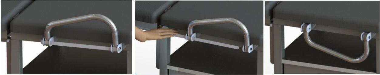
**Figura 70. Desplazamiento del seguro de agarraderas.** Fuente: elaboración propia
