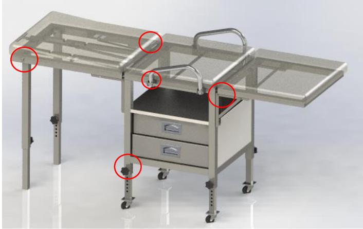
**Figura 76. Uniones de la mesa auxiliar.** Fuente: elaboración propia
