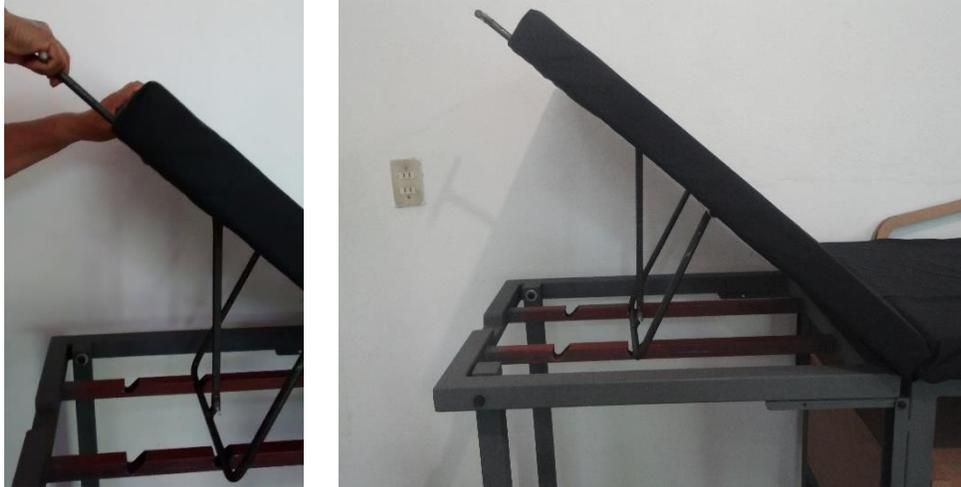
Figura 81. Accionamiento del mecanismo de respaldo. Fuente: elaboración propia
