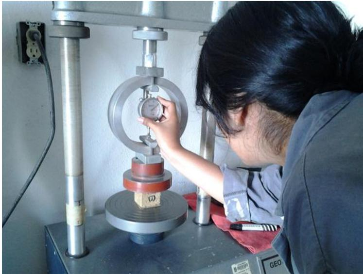
*Fig. 3.3.4.1. Colocación en 0 del micrómetro de la máquina.
