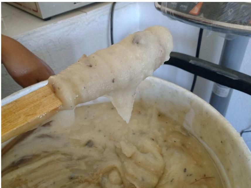
Fig. 3.4.3. Resina de pino utilizada para la elaboración de adobes. Fuente: El tesista.
