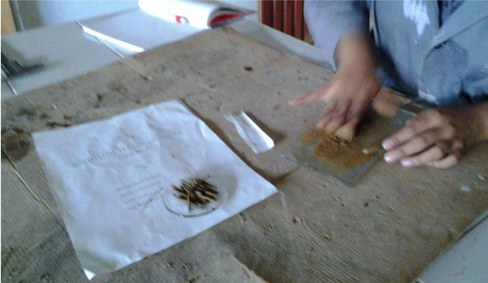
*Fig. 3.2.3.1.* Muestra en forma de mini cilindros para límite plástico. Fuente: El tesista.
