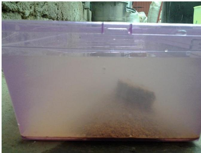
*Fig. 3.3.3.1.1.* Cubo de suelo solo al momento de haberse sumergido completamente.
