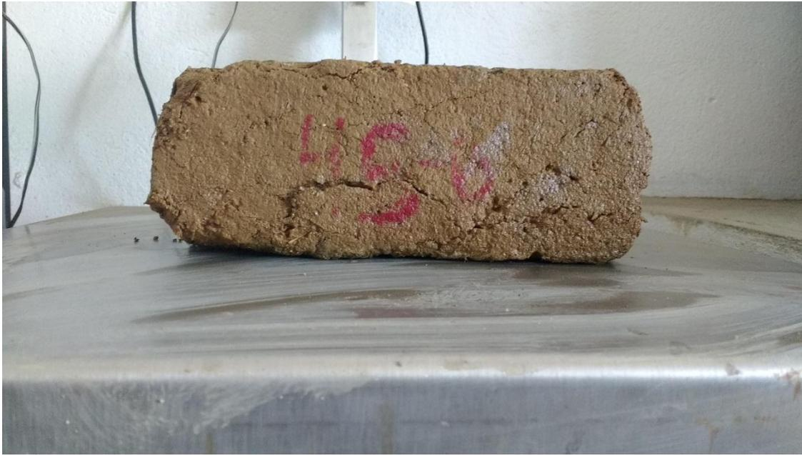
*Fig. 3.4.2.2.* Adobe con resina en báscula. Los especímenes de suelo, estiércol y resina no se deshicieron y pudieron pesarse pasadas las 24 horas. Fuente: El tesista.
