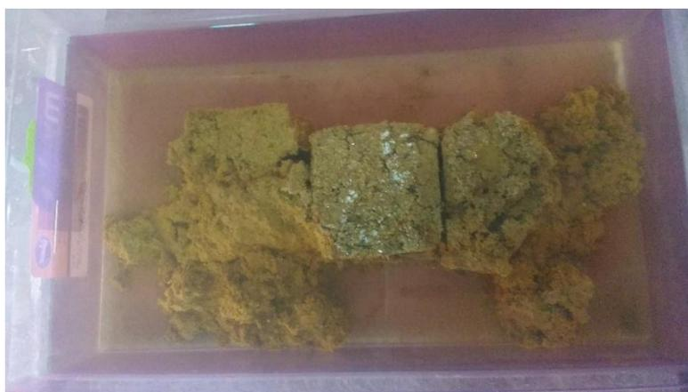
*Fig. 3.3.3.1.12.* Cubos de suelo + 20% de resina de pino ya deformados. Fuente: El tesista.
