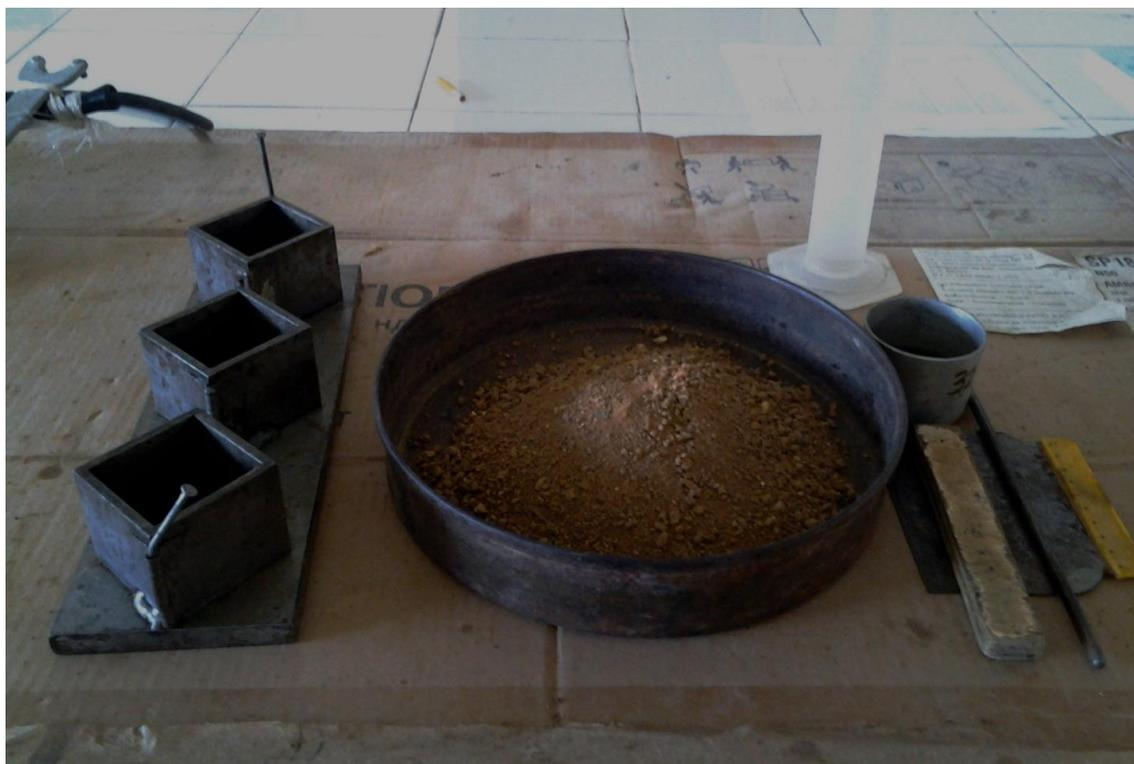
Fig. 3.3.2.1. Material utilizado para la elaboración de cubos: molde para cubos, taras, pisón pequeño, varilla pequeña o desarmador, cuña y probeta. Fuente: El tesista.
