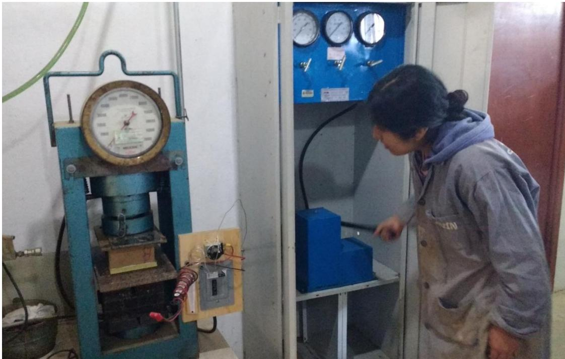
*Fig. 3.4.3.2. Pruebas de compresión en adobe utilizando máquina de compresión manual.*
