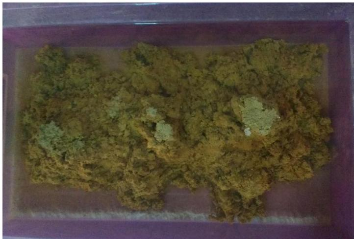
*Fig. 3.3.3.1.14.* Cubos de suelo + 25% de resina de pino ya deformados. Se puede observar la capa blanca en la parte superior de los cubos. Fuente: El tesista.
