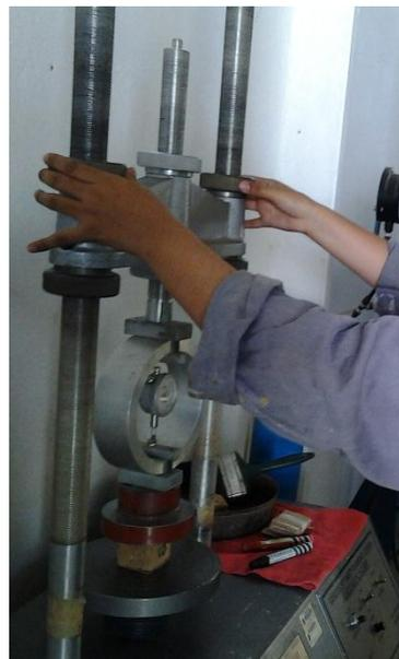
Fig. 3.3.4.2. Ajuste de la altura de la máquina al tamaño del cubo. Fuente: El tesista.
