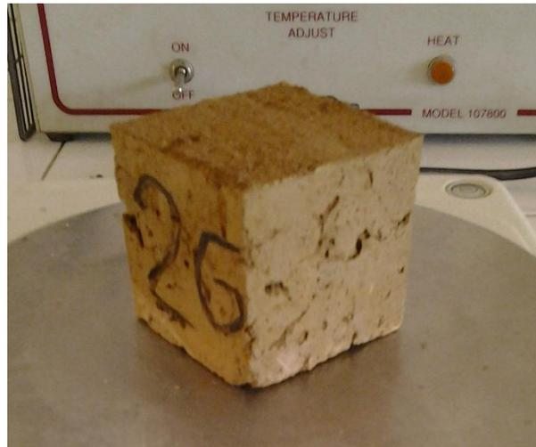
*Fig. 3.3.2.9.* Cubo de suelo y 5% de resina de pino (M5RP). Fuente: El tesista.
