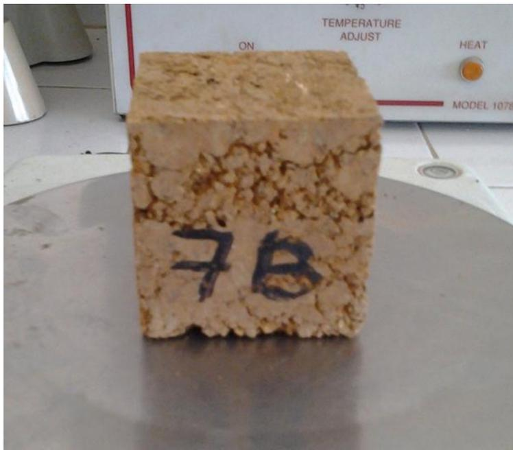
*Fig. 3.3.2.6.* Cubo de suelo + engrudo de trigo diluido. Se puede observar cómo se separó el material. Fuente: El tesista.
