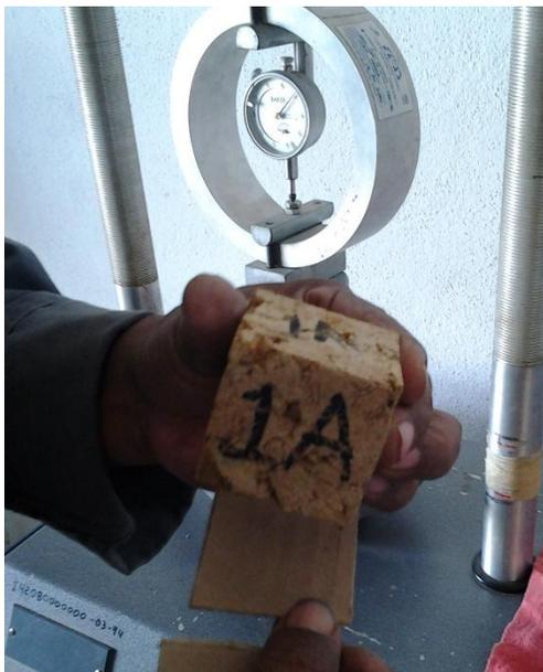
Fig. 3.3.4.1. Colocación de los cuadrados de cartón en el cubo. Fuente: El tesista.
