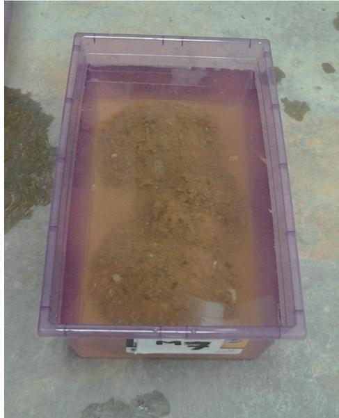
*Fig. 3.3.3.1.5.* Cubos de suelo + 10% engrudo de trigo ya deshechos. Fuente: El tesista.
