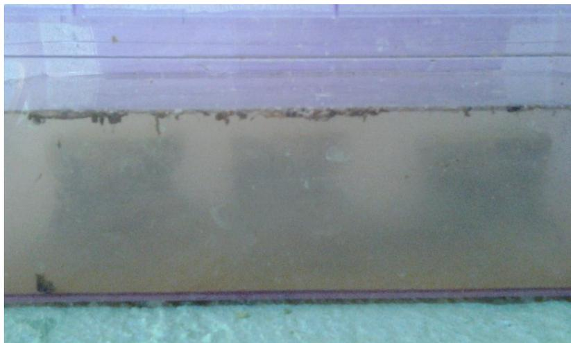
*Fig. 3.3.3.1.15.* Cubos de suelo + excremento de burro al sumergirse en el agua.
