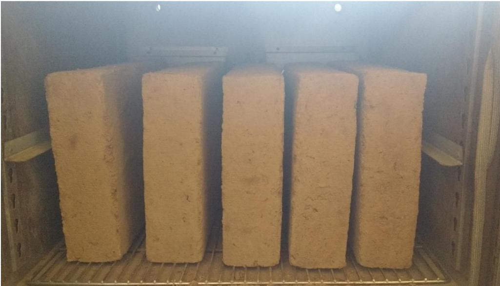
*Fig. 3.4.2.* Cinco de los segundos adobes elaborados. Los que se muestran son de suelo + excremento de burro + resina. Fuente: El tesista.
