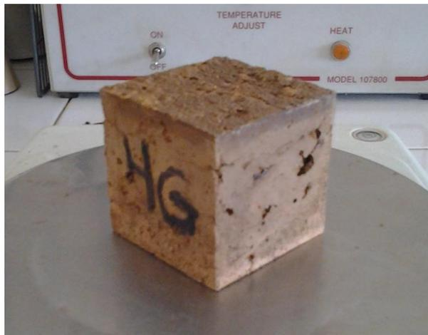
*Fig. 3.3.2.10.* Cubo de suelo y 15% de resina de pino (M15RP). Fuente: El tesista.
