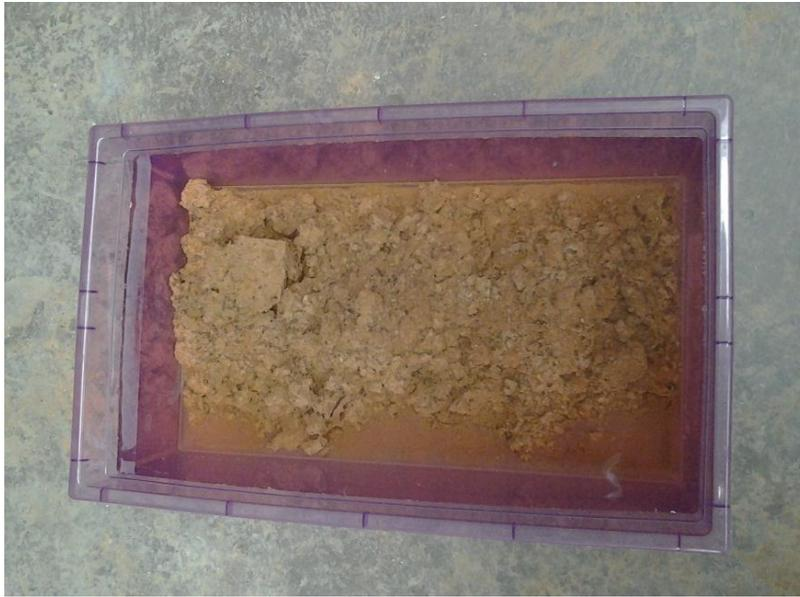
*Fig. 3.3.3.1.9.* Cubos de suelo + 15% de resina de pino al estar sumergidos en el agua. El tesista.
