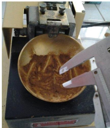
*Fig. 3.2.3.2. Medición de la muestra unida a los 25 golpes.*
