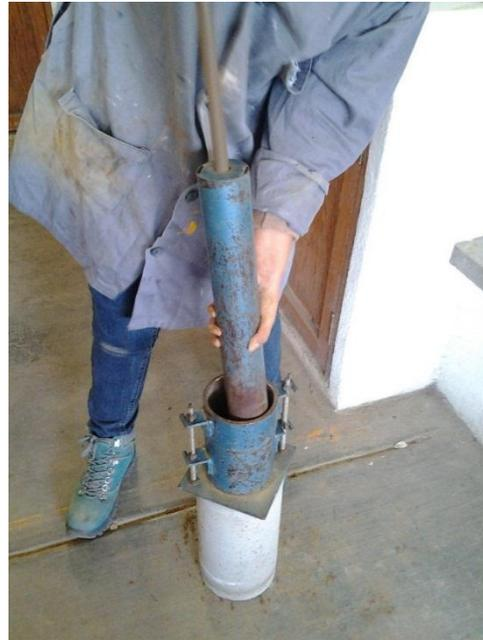
*Fig. 3.2.5.2.* Compactación del suelo utilizando el pisón. Fuente: El tesista.
