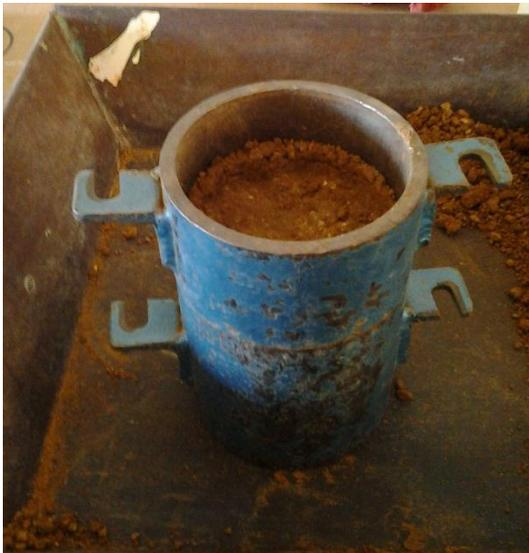
*Fig. 3.2.5.3.* Molde con el suelo ya compactado, sin pasar los 2.5 cm. Fuente: El tesista.
