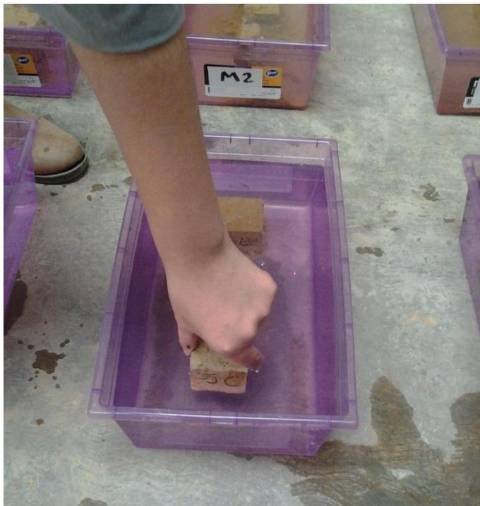
*Fig. 3.3.3.1.* Proceso de inmersión de los cubos: por bandeja se sumergieron los tres cubos de cada muestra. Fuente: El tesista.
