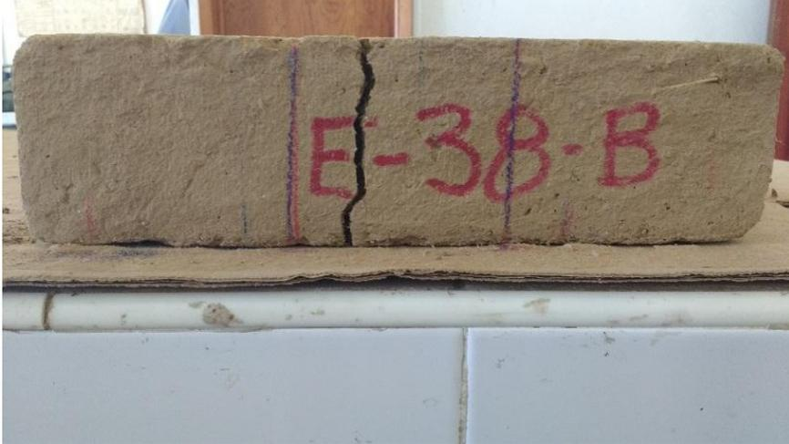
*Fig. 3.4.4.2. Ubicación de la fractura.*
