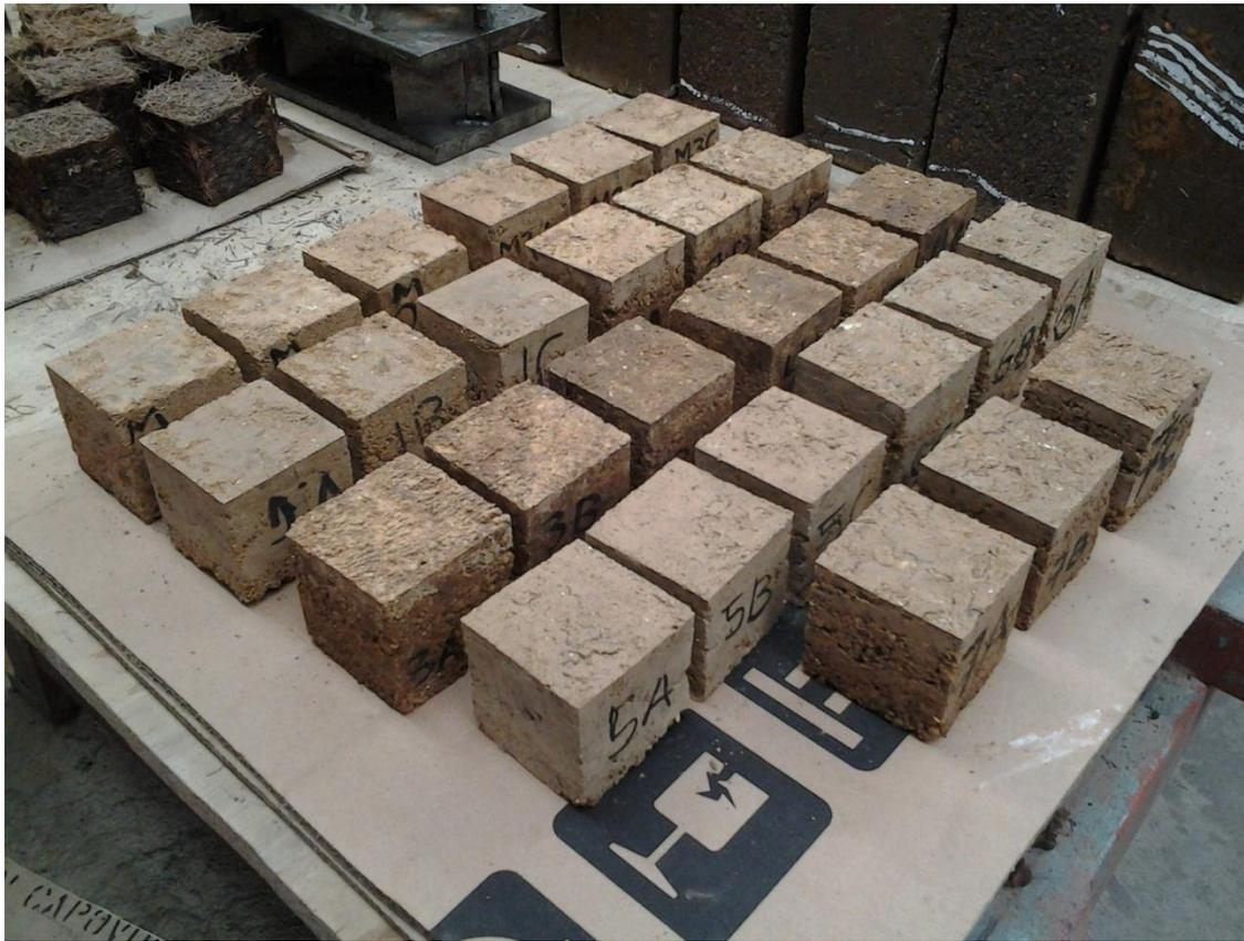
Fig. 3.3.2.8. Cubos secando; se observan distintos colores en las muestras. Fuente: El tesista.
