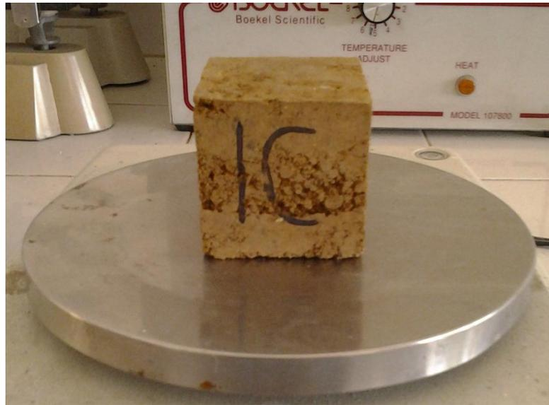
*Fig. 3.3.2.3. Cubo de suelo solo. Fuente: El tesista.*
