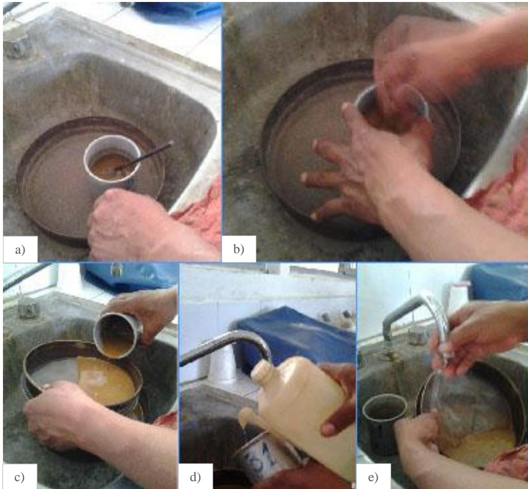
*Fig. 3.2.2.4.* Lavado de la muestra mediante movimientos en forma de “8s” pasando por la malla núm. 200. a) Muestra en vaso b) Mezclado c) Vaciado de la muestra revuelta en tamiz d) Uso de piseta para verter el material retenido en el vaso e) Lavado de la muestra en el tamiz.
