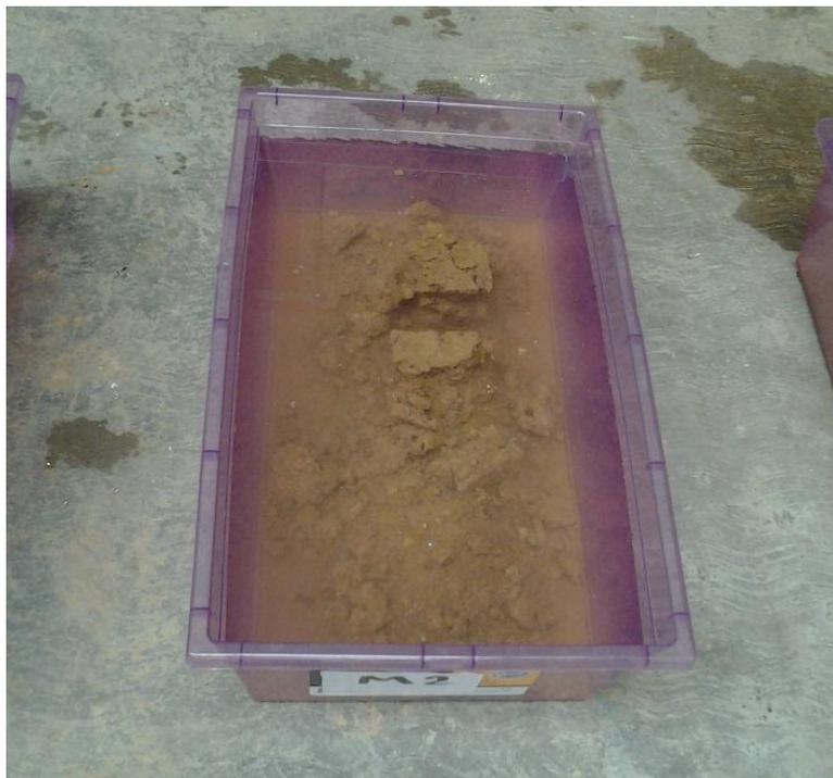
*Fig. 3.3.3.1.8. Cubos de suelo + 5% de resina de pino. Fuente: El tesista.*
