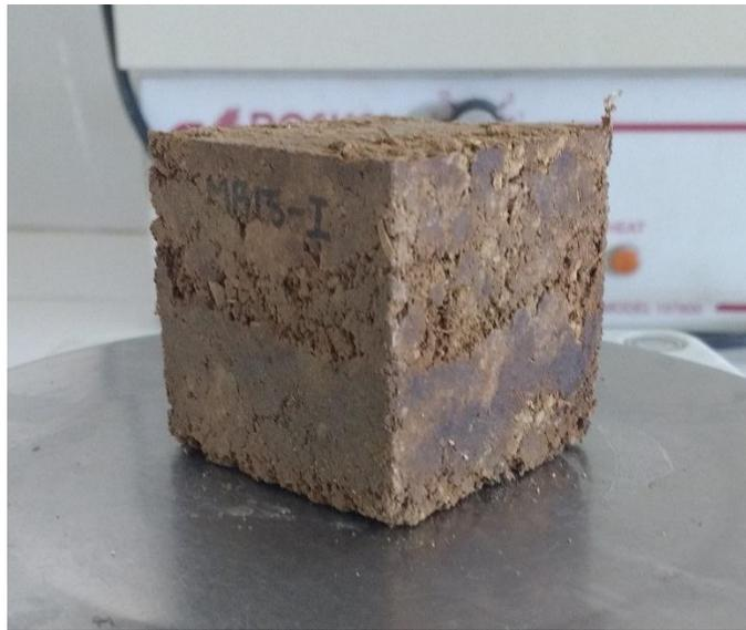
*Fig. 3.3.2.14.* Cubo con suelo, excremento de burro y 15% de resina de pino (MSERP15).
