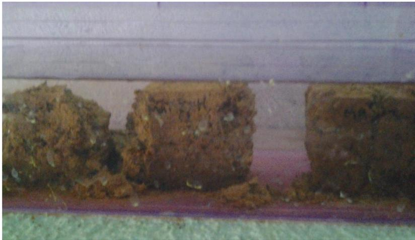
*Fig. 3.3.3.1.17.* Cubos de suelo + excremento de burro + 15% de resina de pino al estar sumergidos en el agua. Fuente: El tesista.
