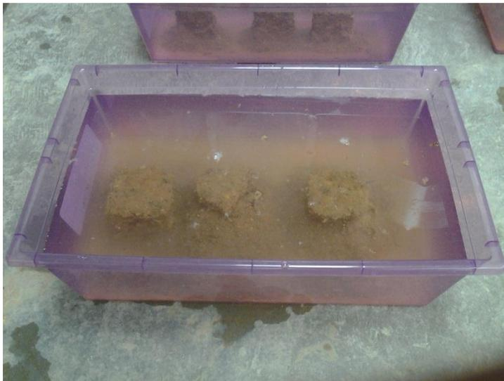
*Fig. 3.3.3.1.4.* Cubos de suelo + 5% hoja de plátano molida. Fuente: El tesista.
