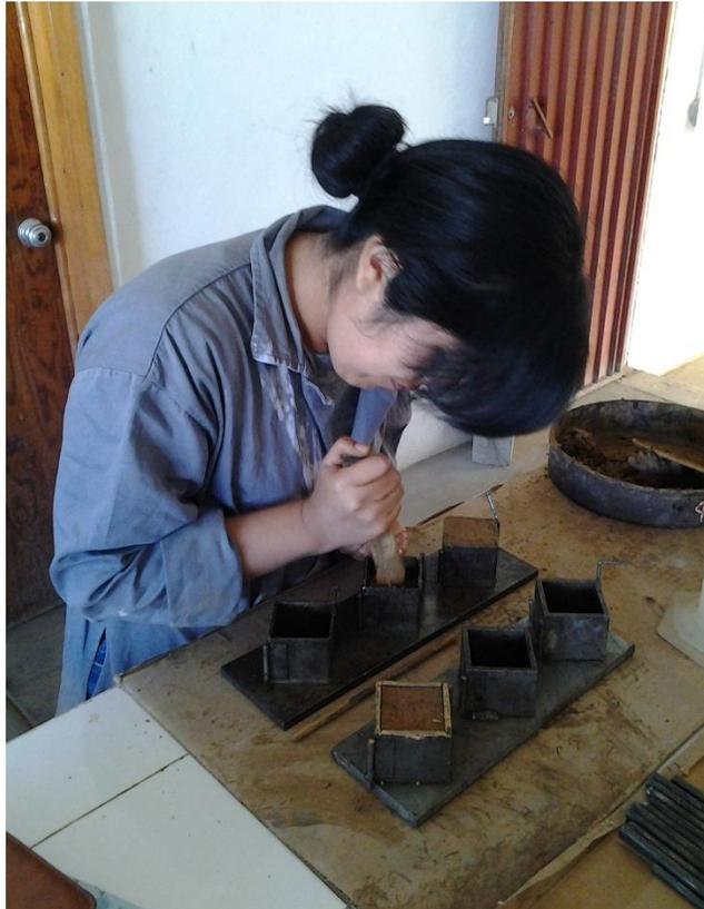
Fig. 3.3.2.2. Compactación de la mezcla en los cubos usando el pisón pequeño. Fuente: El tesista.
