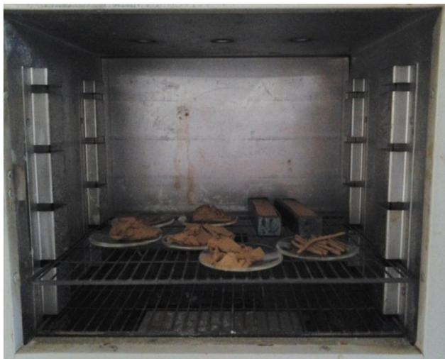
*Fig. 3.2.3.2.* Muestras de límites de consistencia puestos a secar en horno. Fuente: El tesista.
