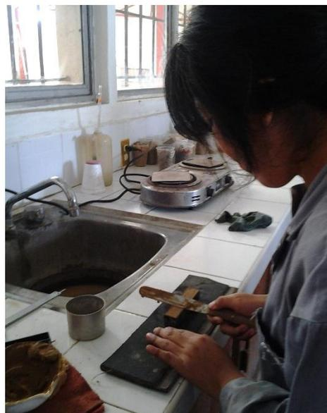
*Fig. 3.2.3.4. Elaboración de muestras para contracción lineal.* Fuente: El tesista.
