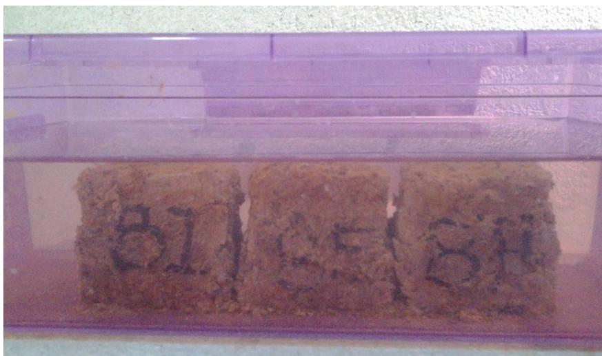
*Fig. 3.3.3.1.11.* Cubos de suelo + 20% de resina de pino al estar sumergidos en el agua. Fuente: El tesista.
