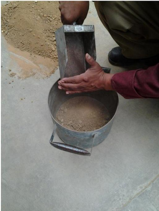
Fig. 3.2.2.2. Depósito de tierra en forma de cruz en la tara la tierra. Fuente: El tesista.
