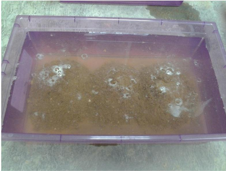
*Fig. 3.3.3.1.3.* Cubos de suelo + 5% jugo de hoja de plátano. Cuando ya estaban deshechos empezaron a sacar burbujas. Fuente: El tesista.
