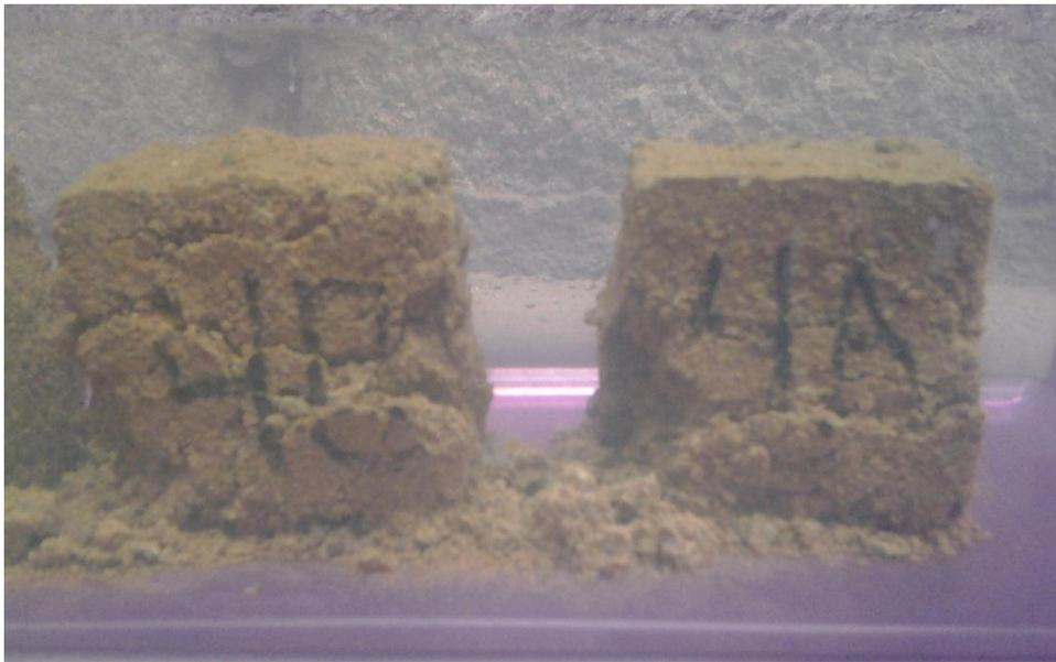
*Fig. 3.3.3.1.10.* Cubos de suelo + 15% de resina de pino ya deformados. Fuente: El tesista.
