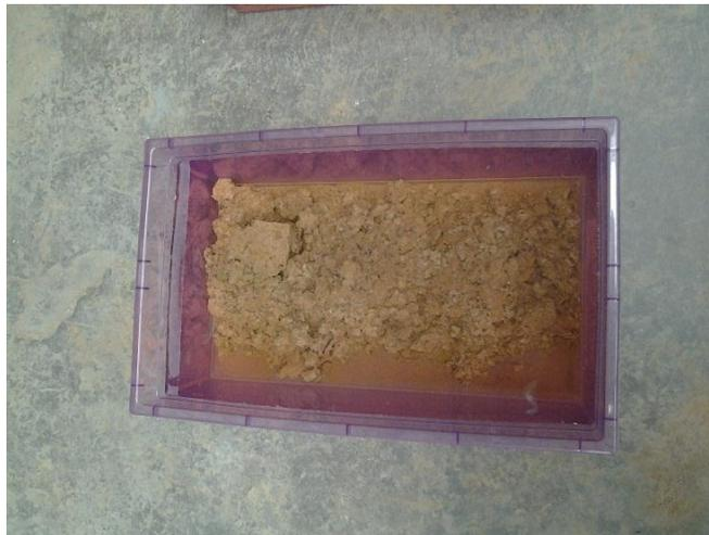
*Fig. 3.3.3.1.7.* Cubos de suelo + 10% de resina, su degradación fue gradual. Fuente: El tesista.
