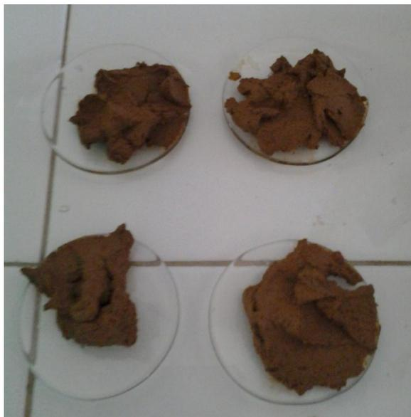
*Fig. 3.2.3.3. Muestras obtenidas del límite líquido.* Fuente: El tesista.
