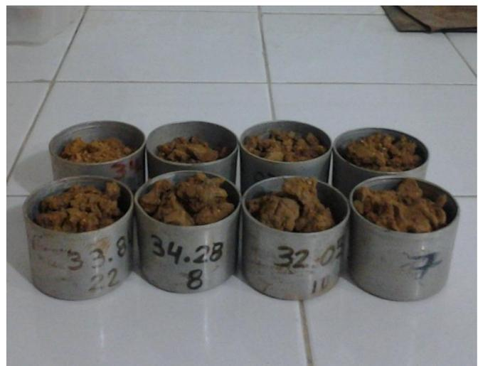
*Fig. 3.2.5.4.* Cápsulas con la muestra de suelo compactado. Fuente: El tesista.
