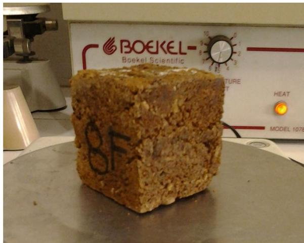
*Fig. 3.3.2.11.* Cubo de suelo y 20% de resina de pino (M20RP). Fuente: El tesista.
