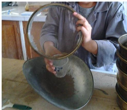
*Fig. 3.2.2.6.* Obtención de la granulometría fina pesando el material que pasó cada malla utilizada.
