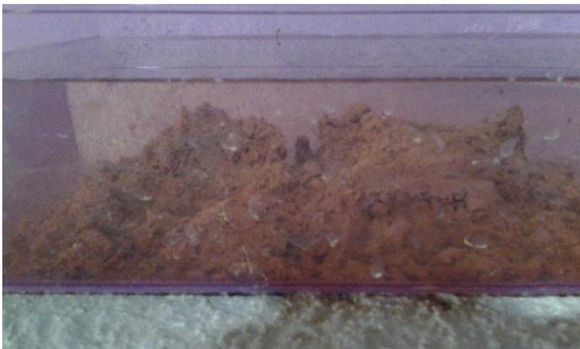
*Fig. 3.3.3.1.18.* Cubos de suelo + excremento de burro + 15% de resina de pino ya deformados. Fuente: El tesista.
