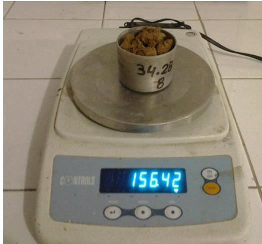
Fig. 3.2.5.5. Cápsulas con las muestras de suelo compactado. Fuente: El tesista.
