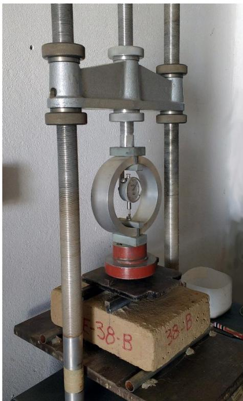
*Fig. 3.4.4.1.* Colocación de bloque para prueba de resistencia a la flexión.
