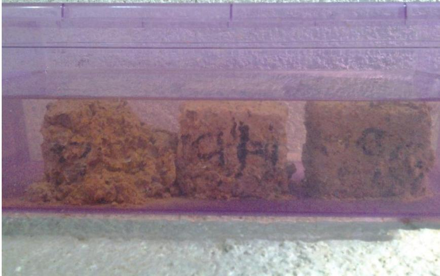
*Fig. 3.3.3.1.13.* Cubos de suelo + 25% de resina de pino al estar sumergidos en el agua.
