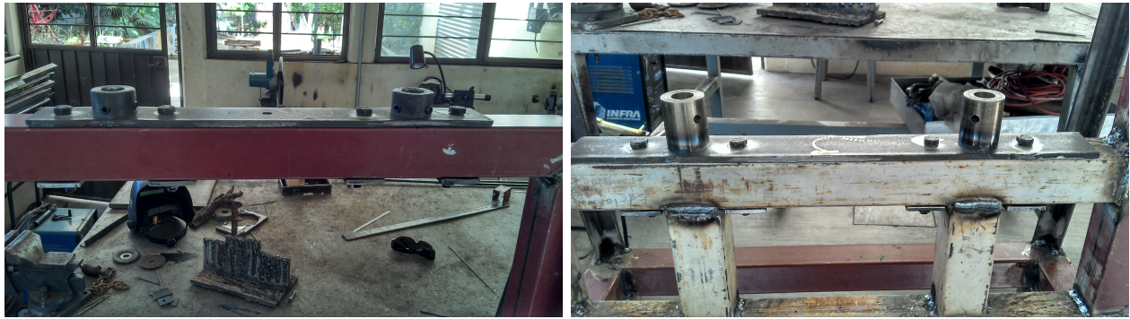
Figura 3.29: Calibración del posicionamiento paralelo de las guías mediante 2 prisioneros M8x1.25 de acero grado 8 en cada buje de sujeción: calibradores superior (izquierda) e inferior (derecha).
