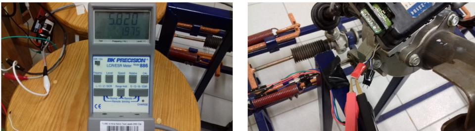
Figura 5.5: Medición de la inductancia de las bobinas.
