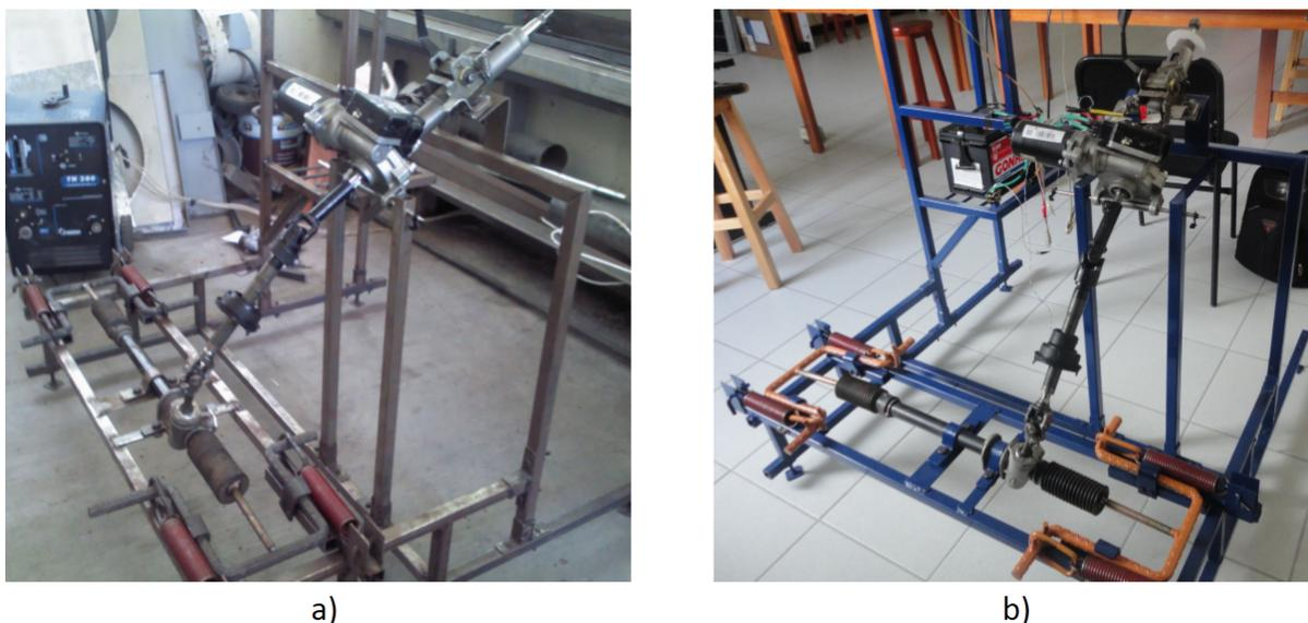
Figura 3.20: Plataforma de dirección automotriz asistida eléctrica.
