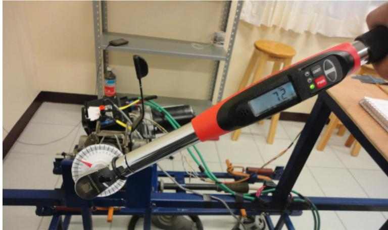
Figura 6.1: Medición del par en la columna de dirección.
