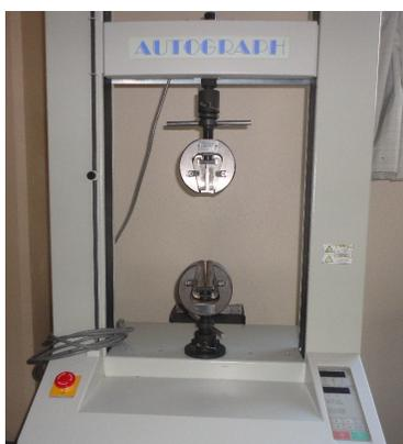
Figura 3.4: Máquina de ensayos Shimadzu Autograph AGS-J Series.
