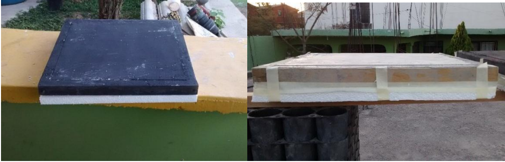
Figura 7.3. Muestra el aislamiento de las placas de ferrocemento.
