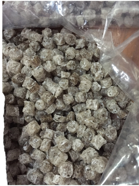
Figura 3.12b Material segmentado con dimensiones: 5mm de longitud y 5mm de diámetro.
