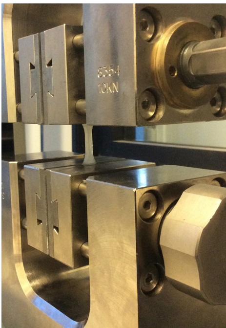
Figura 3.20a Muestra de HDPE durante el ensayo a tensión.
