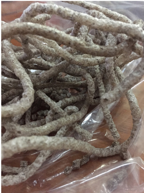
Figura 3.12a Material extruido continuo.
