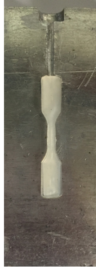
Figura 3.18 Muestra inyectada aún dentro de la cavidad del molde.
