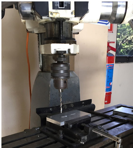
Figura 3.15 Taladro de banco con una de las cavidades montadas en la platina.
