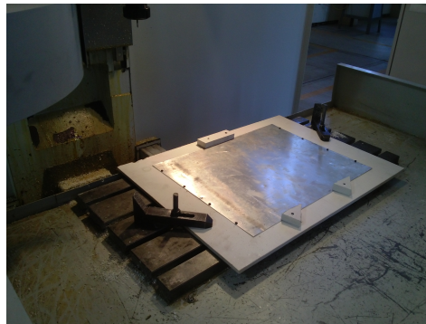
Figura 5.8: Placa de aluminio montada sobre la máquina CNC.
