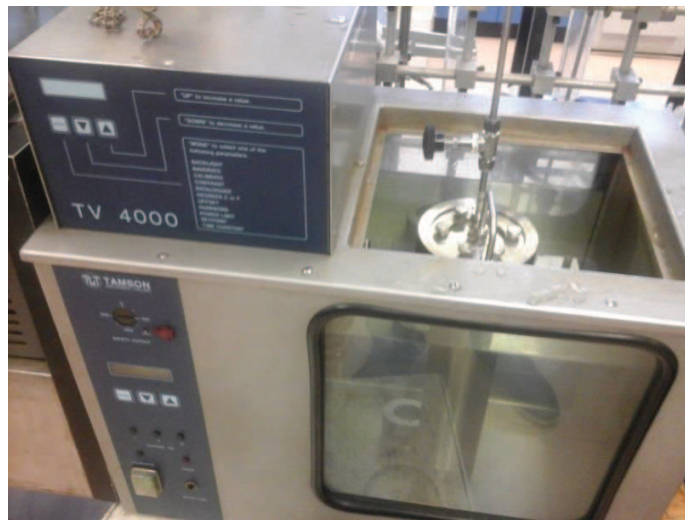
Fig. 17. Prueba de sellado de la celda de extracción.
