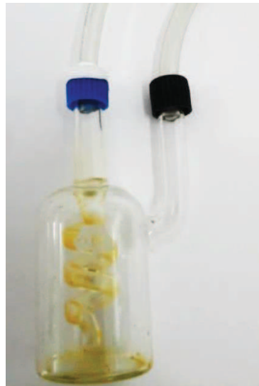
Fig. 27. Aceite esencial de hierbabuena extraído con CO 2 supercrítico.
