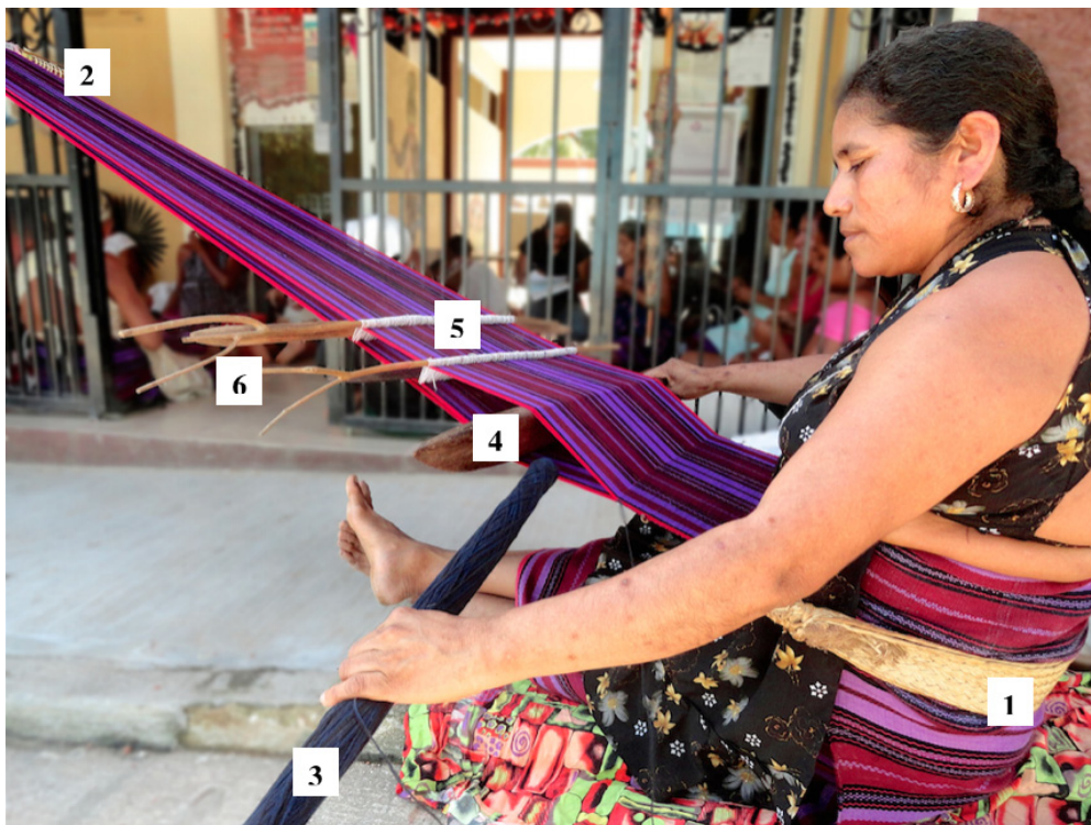
Fig. 26. Partes del telar de cintura de Pinotepa de don Luis.
