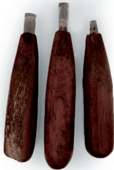
Fig. 18. Herramienta utilizada para labrar jícara.
