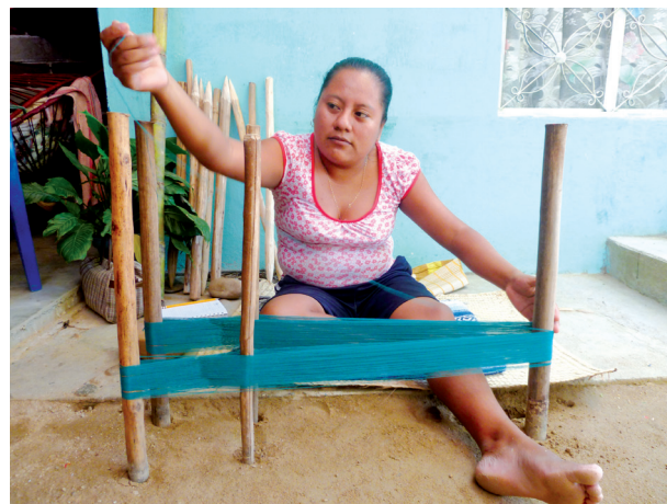
Fig. 31. Urdido realizado con ayuda de estacas colocadas en la tierra.
