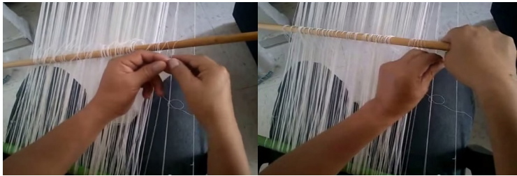
Fig. 32. Colocación de corazón en la urdimbre de telar de cintura.
