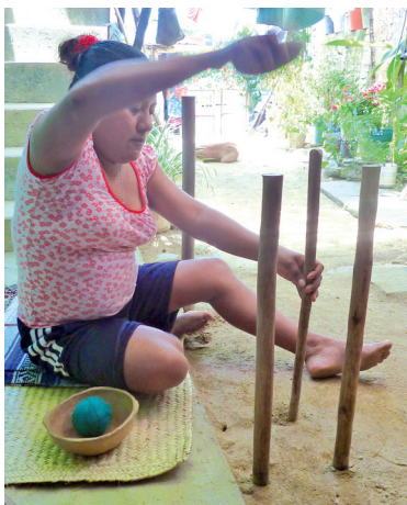
Fig. 30. Colocación de estacas para realizar el urdido.
