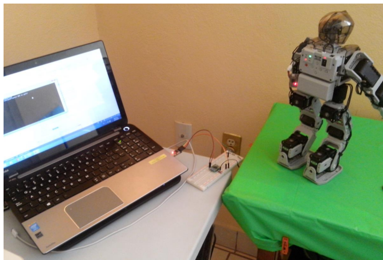
Figura 6.6: Conexión Final USB-Zigbee del robot humanoide Bioid.
