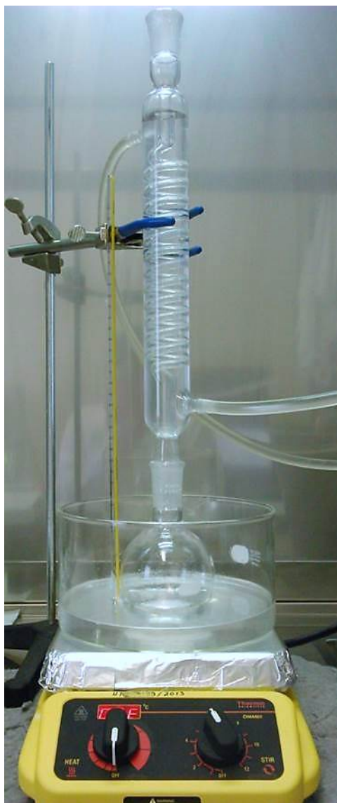
Figura 4.1. Arreglo experimental usado para la preparación de la solución precursora.
