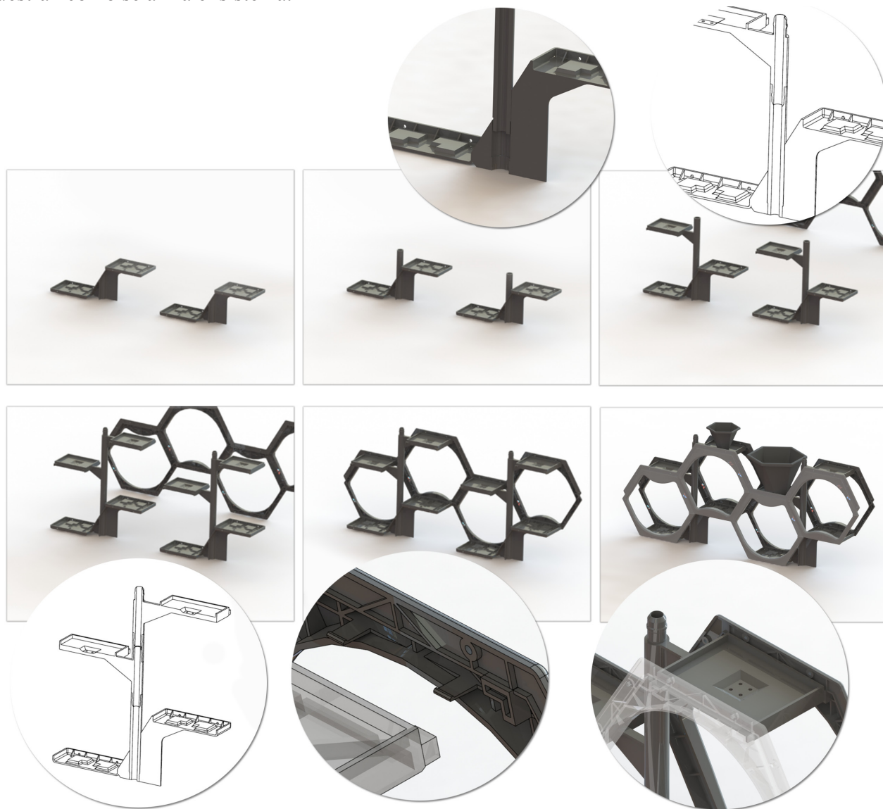
Figura 65. Detalles de uniones con la secuencia de armado del módulo. Fuente: Elaboración propia.
